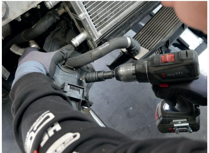
9. Montieren Sie nun die Kunststoffseitenteile sowie den originalen Wasserkühler in umgekehrter Reihenfolge und prüfen Sie nochmal die Freigängigkeit der Bauteile, gerade in dem Bereich der Anschlüsse des Zusatz-Wasserkühlers.
