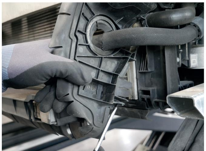
4. Lassen Sie nun den serienmäßigen Wasserkühler sowie die Kunststoffseitenteile so weit wie möglich nach unten hängen, um Platz für den Einbau des HF-Series Zusatz-Wasserkühlers zu haben.
