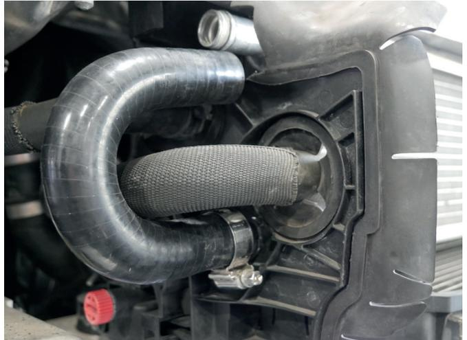
11. Klemmen Sie jetzt die Wasserleitung (beifahrerseitig) zum originalen Wasserkühler mit entsprechendem Werkzeug ab.
