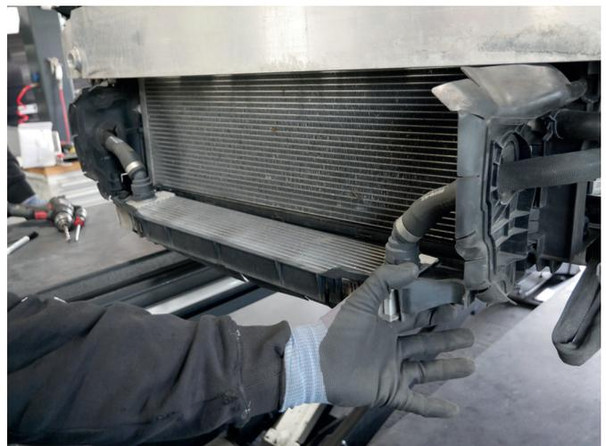
3. Lösen sie nun die Halteclips der Kunststoffseiten des serienmäßigen Wasserkühlers. Benutzen Sie auch dort am besten einen Schlitzschraubendreher oder ähnliches. Diese ziehen Sie dann auch aus ihrer Befestigungsposition.
