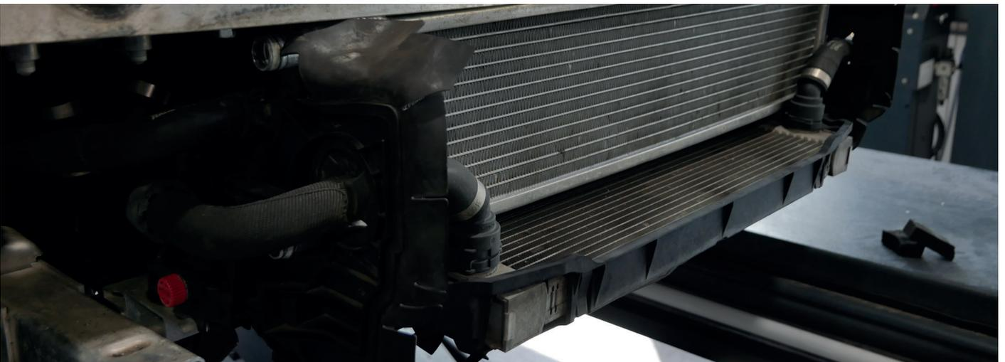
10. Montieren sie nun eine Seite des mitgelieferten Silikonbogen 180° am unteren Anschluss des Zusatz-Wasserkühler (beifahrerseitig). Fixieren Sie das Ende mit einer der mitgelieferten Schlauchschellen und einem 7er T-Griff.
