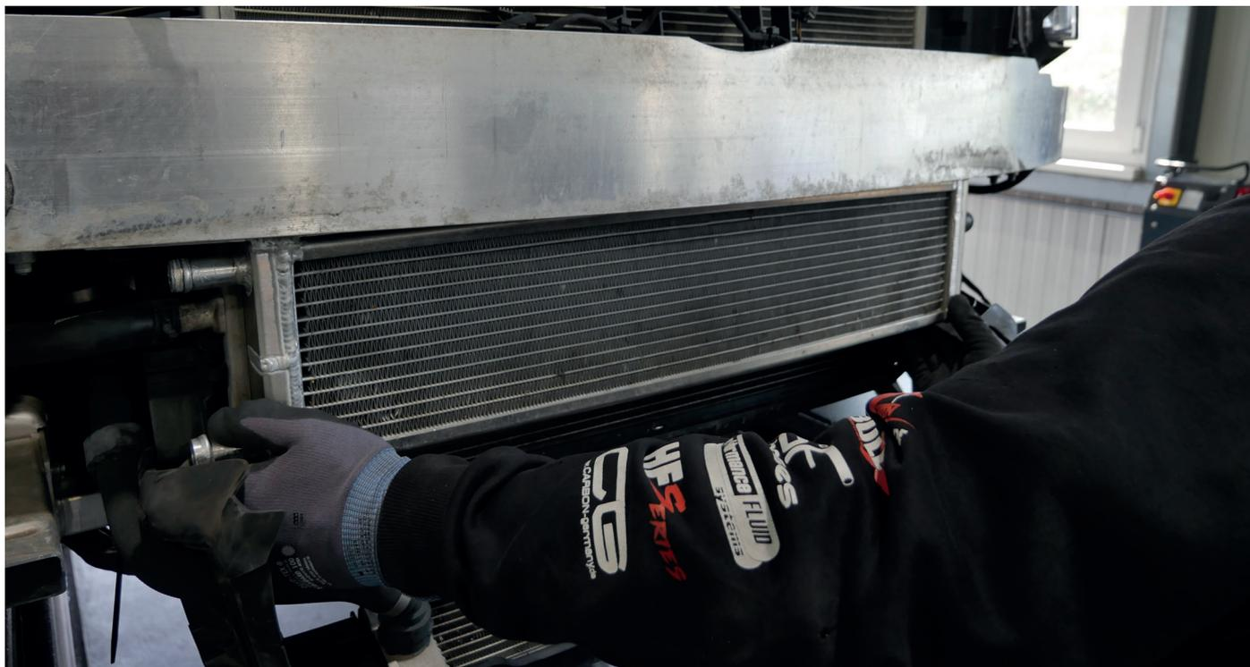
6. Schrauben Sie nun den HF-Series Zusatz-Wasserkühler auf beiden Seiten mit den mitgelieferten Blechschrauben und einer 7er Nuß (idealerweise mit Verlängerung auf einem Akkuschrauber) von unten an dem Prallschutzträger fest.
