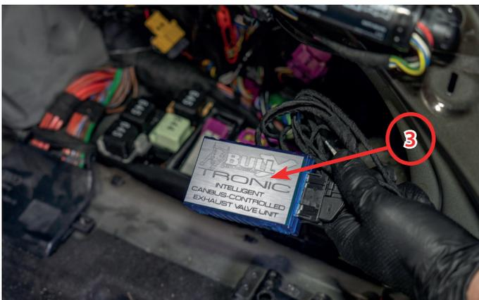
Anweisungen für den Anschluss des Kabelsatzes
