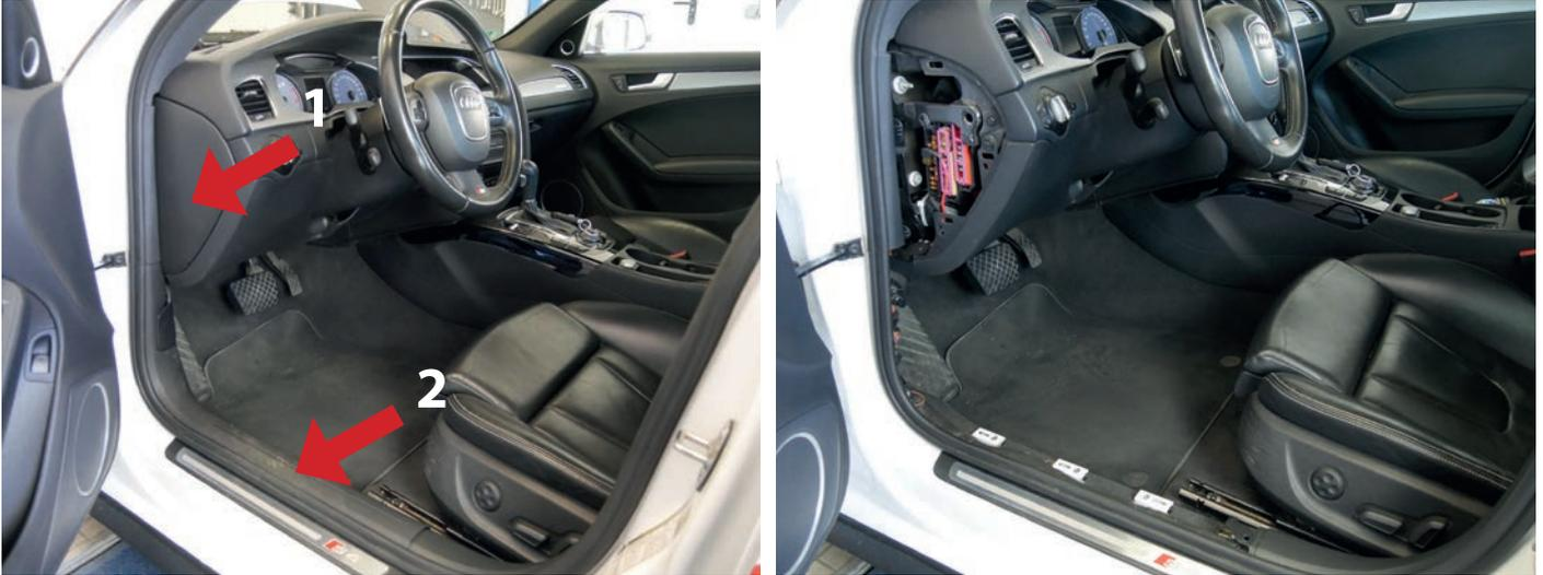
2. Unter der Abdeckung am Amaturenbrett befindet sich der Sicherungskasten, an dem Sie die benötigten geschalteten 12 + V finden. Messen Sie dafür die Leitungen an verschiedenen Stellen durch, bis sie es gefunden haben und verbinden diese Leitung dann mit der von der Bull-X Tronic kommenden Leitung.
