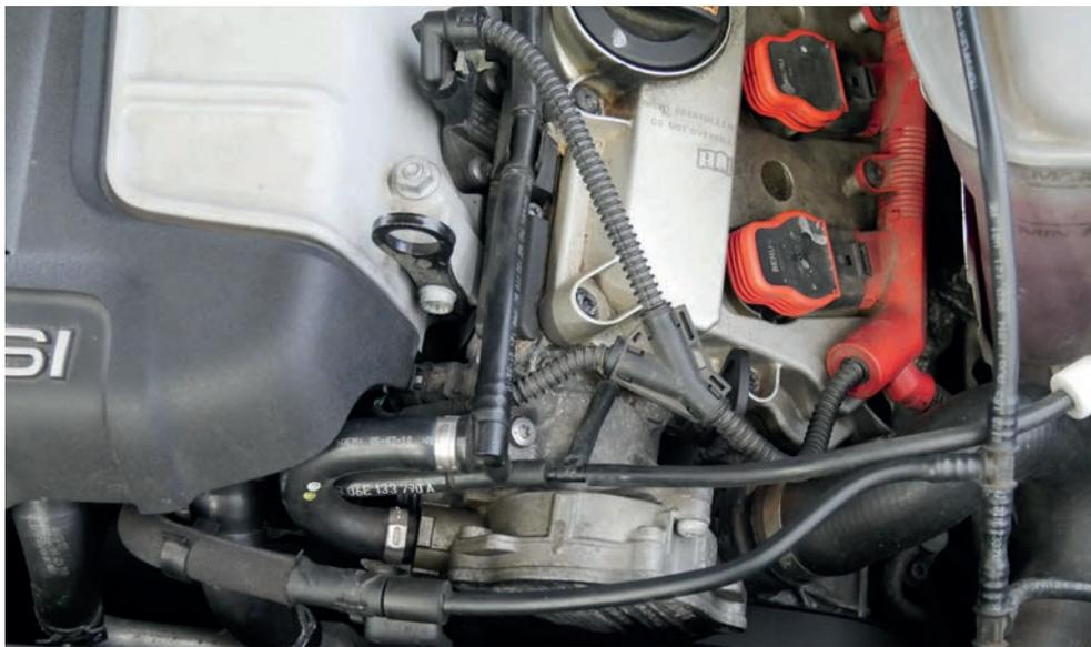
3. Das Rückschlagventil an geeigneter Stelle in die Unterdruckleitung einsetzen (Richtung beachten).
