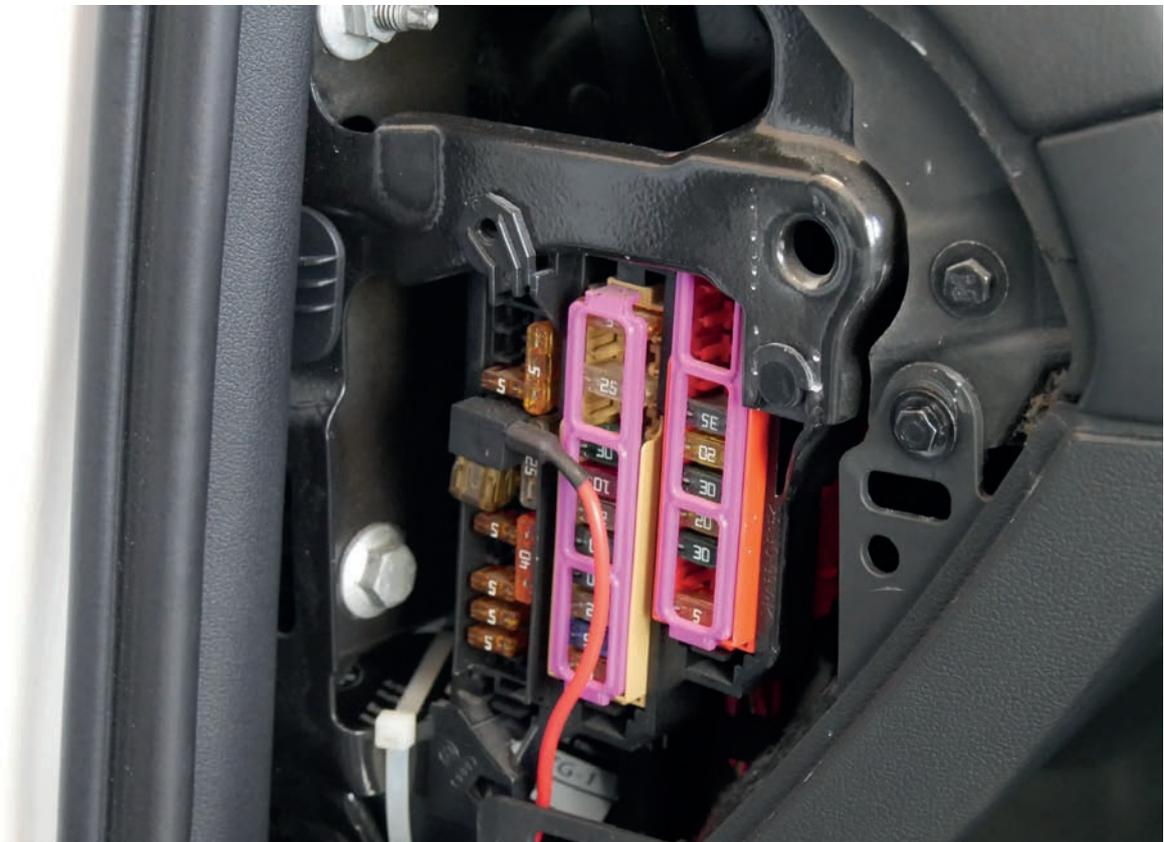
3. Im Bereich des Seitenschwellers befindet sich ein **Massepunkt (1)**, daran können Sie die Masseversorgung der Bull x Tronic anschließen ( 10 mm Ring- oder Maulschlüssel)
