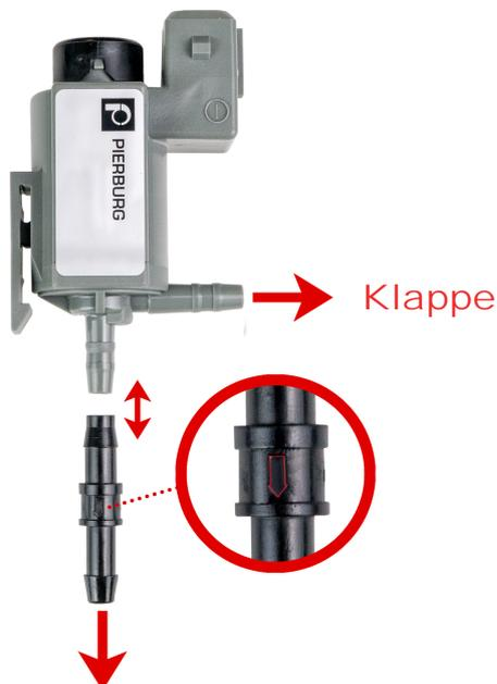
Unterdruckanschluss am Motor
