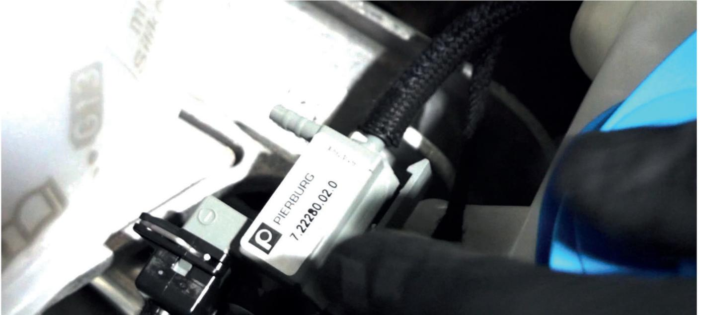
11. Verlegen Sie den Unterdruckschlauch im Motorraum so, dass er nirgends eingeklemmt wird, scheuert oder abreißen kann und sichern Sie ihn in regelmäßigen Abständen mit Kabelbindern.
