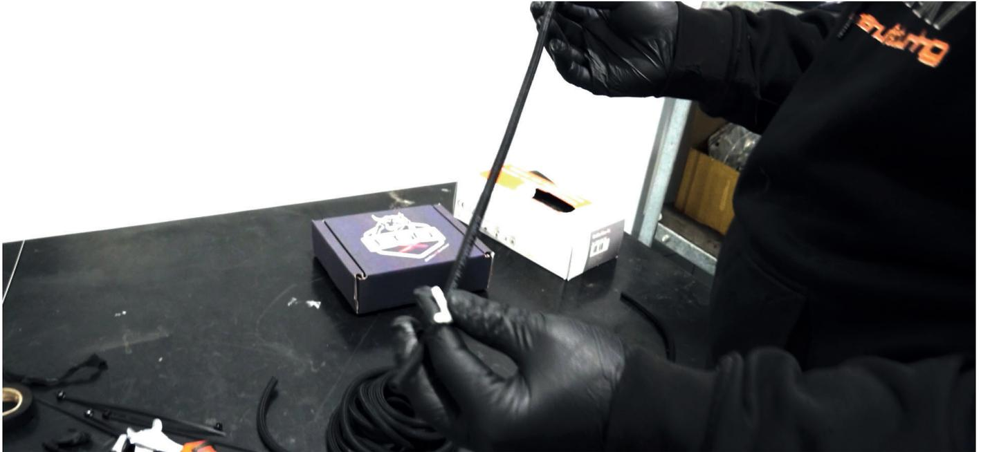
8. Stecken Sie dann das Rückschlagventil auf das andere Ende des langen Schlauchstücks. Achten Sie dabei auf den Pfeilrichtung auf dem Rückschlagventil sowie auf die Hinweise in den „Allgemeinen Einbauhinweisen“.
