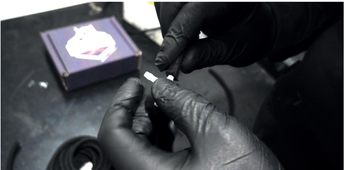
7. Stecken Sie ein ca. 50cm langes Stück Unterdruckschlauch auf das gegenüberliegende Ende des T-Stücks, so dass es aussieht wie auf dem unteren Bild.
