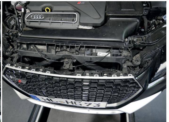
2. Die Luftleitbleche müssen so positioniert sein, dass die Haltetaschen Richtung Motorraum zeigen und das Loch in der Luftführungsfläche jeweils zur Fahrzeugmitte. So werden die Bleche dann nacheinander zwischen Kühlergrill und Frontmaske platziert, so dass die Haltetaschen wie gezeigt auf der Frontmaske aufliegen.
