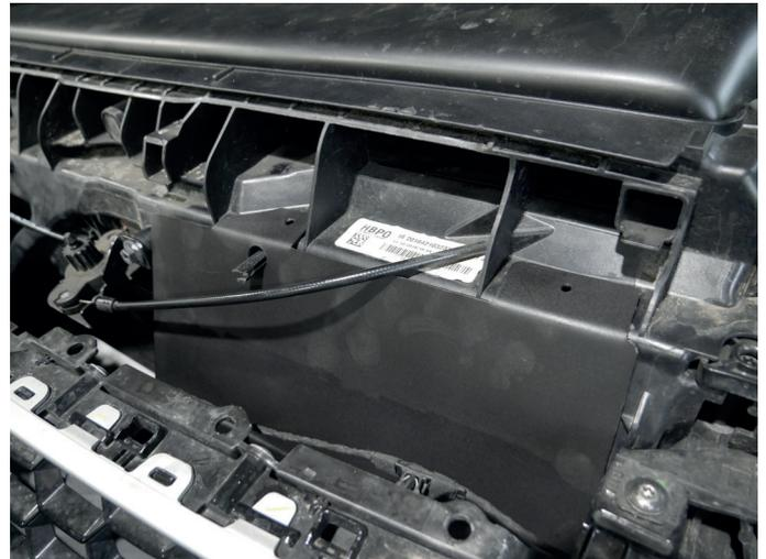
3. So positioniert, halten Sie jeweils ein Blech in Position und bohren mit einem 3mm Metall- oder Kunststoffbohrer durch die Löcher der Haltetaschen in die Frontmaske des Fahrzeug. Achten Sie dabei auf umliegende Fahrzeugteile. Danach fixieren Sie die Luftleitbleche mit den mitgelieferten Grobgewindeschrauben.
