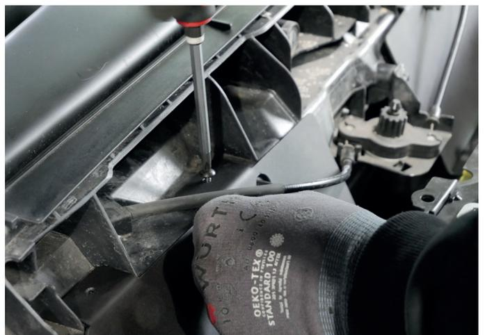
4. Wenn sich nun die Luftleitbleche wie gezeigt in ihrem Fahrzeug befinden, können sie die obere Schloßträgerabdeckung wieder einbauen und mit den zuvor entfernten Kunststoffnieten fixieren.
