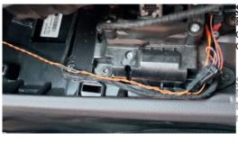
Führen Sie das Kabel nun geeignet durch die Mittelkonsole, sodass es nicht beschädigt werden kann.
