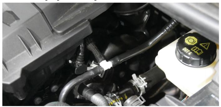
17. Verlegen Sie nun die Unterdruckleitung vom verbleibenden Anschluss des Magnetventils (2) in Richtung Unterboden des Fahrzeugs.
