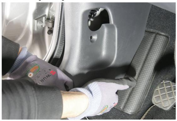
6. Entfernen Sie vorsichtig an gezeigter Stelle das Gewebeband mit einem Seitenschneider.
