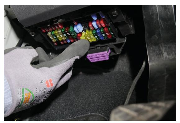
10. Stecken Sie die zuvor entfernte Sicherung in den Sicherungshalter (dieser ist im Lieferumfang enthalten und stecken diesen dann in den freien Steckplatz der zuvor entfernten Sicherung. Nun können Sie an dem roten Kabel des Sicherungshalters (mit 10 Ampere abgesichert) Zündungsplus der Bull-X Tronic anschließen.
