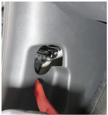
4. Hebeln Sie mit dem Plastikkeil das Verkleidungsteil am Einstieg soweit hoch, dass Sie mit den Fingern untergreifen können und ziehen Sie mit einem leichten Ruck das Verkleidungsteil in Richtung Fußraum ab. HINWEIS: Beim Abziehen bleiben die Befestigungsstifte oft in der Karosserie stecken. Ziehen Sie die Stifte heraus und setzen Sie diese wieder in das Verkleidungsteil ein.
