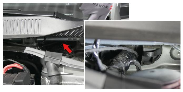
15. Verlegen Sie das Kabel im Wasserkasten des Fahrzeugs in Richtung Beifahrerseite zum Magnetventil (1).
