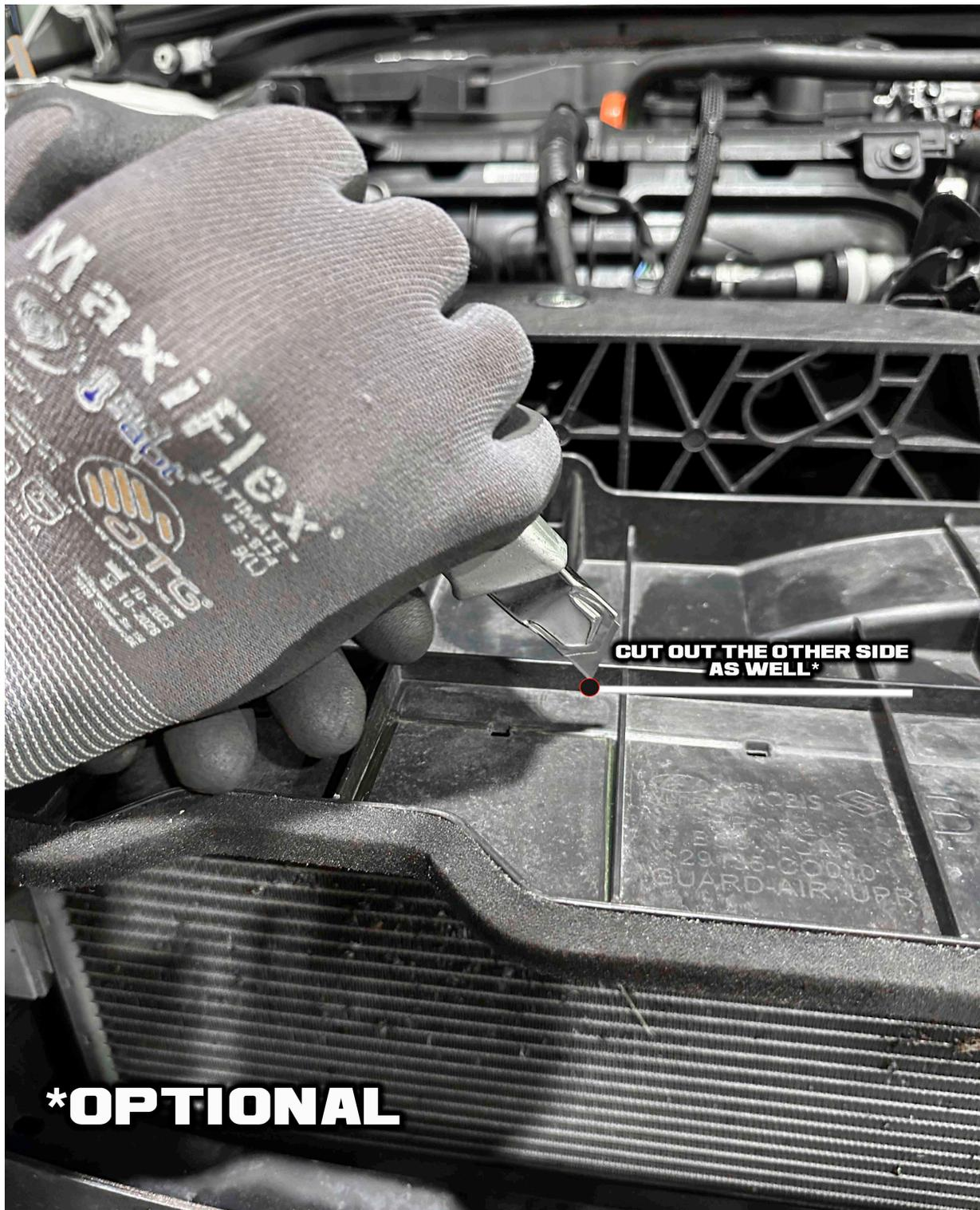
3. Setzen Sie nun das HF Series Luftleitblech an die Stelle an dem der Ausschnitt erfolgt ist.
