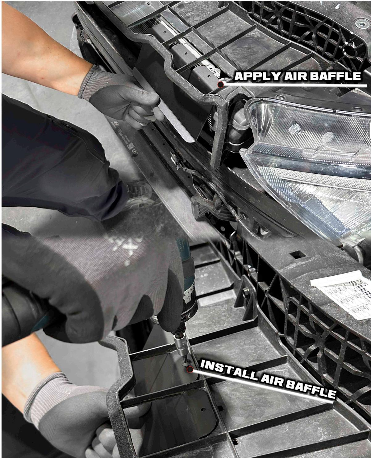
5. Das Luftleitblech ist nun vollständig montiert und einsatzbereit.
