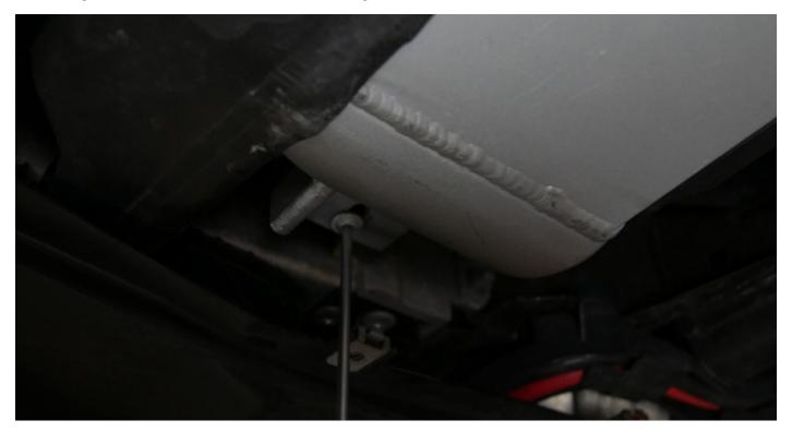
8. Stecken Sie nun die Ladelüftschläuche auf die Anschlüsse des Kühlers und drücken diese fest an. Die Schläuche müssen hörbar, rundherum einrasten und durch wackeln und ziehen, fest mit dem Kühler verbunden sein.
