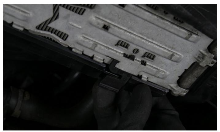
4. Entfernen Sie nun beide links und rechts am Kühler befindlichen T25 Befestigungsschrauben und ziehen den Kühler vorsichtig nach unten aus seiner Halterung.
