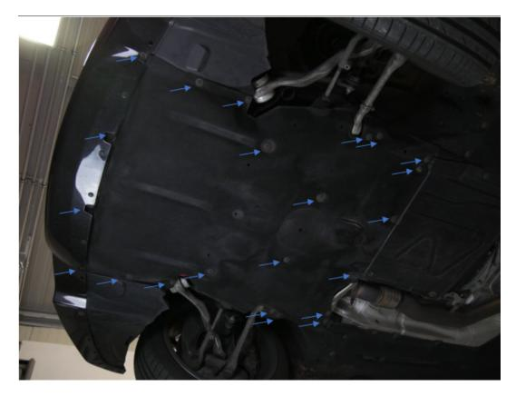
Hinweis: Bevor Sie im folgenden Schritt den Unterfahrschutz wieder montieren, starten Sie das Fahrzeug und prüfen Sie die Verschlauchung des Ladeluftkühlers auf Dichtigkeit.
