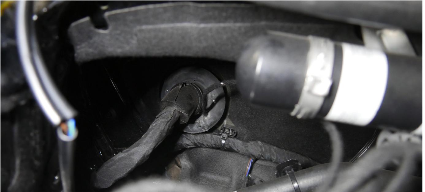
11. Eine geeignete Unterdruckanschlussquelle finden Sie rechts hinten unter der Motorabdeckung. Demontieren Sie die serienmäßige Gummileitung. Stecken Sie dort ein kurzes Stück Schlauch, das T Stück und den Unterdruckschlauch zum Rückschlagventil an. Verbinden Sie danach den abgezogenen Serien Schlauch wieder an das T-Stück an.
