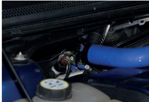
6. Als letzten Schritt schließen Sie das Magnetventil mit dem Unterdruckschlauch und dem T-Stück an den originalen Unterdruckschlauch (siehe Foto). Bauen Sie das Handschuhfach wieder ein und befestigen Sie wieder die Plastikabdeckung auf der linken Seite des Armaturenbretts.
