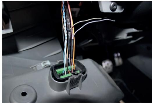
5. Auf der rechten Seite des Armaturenbretts, müssen Sie den Stecker mit dem lila Kabel und dem rot-weißen Kabel von der Bull-X Tronic in den Motorraum ziehen und dort mit dem Magnetventil verbinden. Die Polarität spielt dabei keine Rolle.
