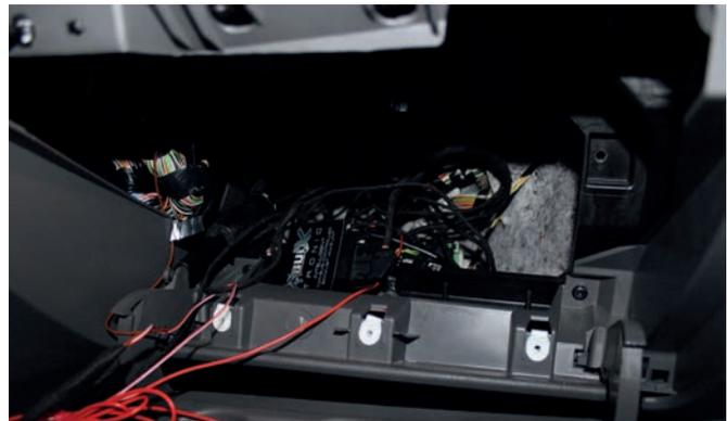
3. Danach bewegen Sie den Sicherungskasten nach unten um einfacher an die Sicherungen zu gelangen. Dann stecken Sie das Zündungs plus -Kabel (ignition plus) in den unten gezeigten freien Sicherungssteckplatz.
