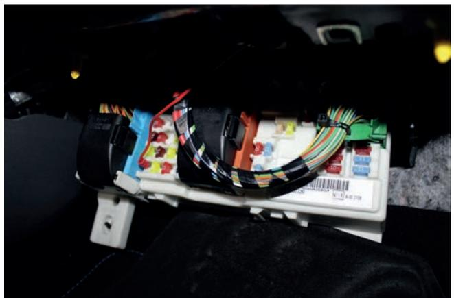
4. Im nächsten Schritt werden das CAN LOW- und CAN HIGH- Kabel hinter das Armaturenbrett gezogen in Richtung des OBD-Steckers (markiert mit Pfeil). Dafür müssen Sie die Schraube entfernen, welche die Abdeckung fixiert. Verbinden Sie das CAN HIGH-Kabel mit dem Kabel welches auf PIN 6 des OBDSteckers sitzt (Rot-Blau) und das CAN LOW-Kabel mit dem Kabel von PIN 14 des OBD-Steckers (Rot-Weiß).
