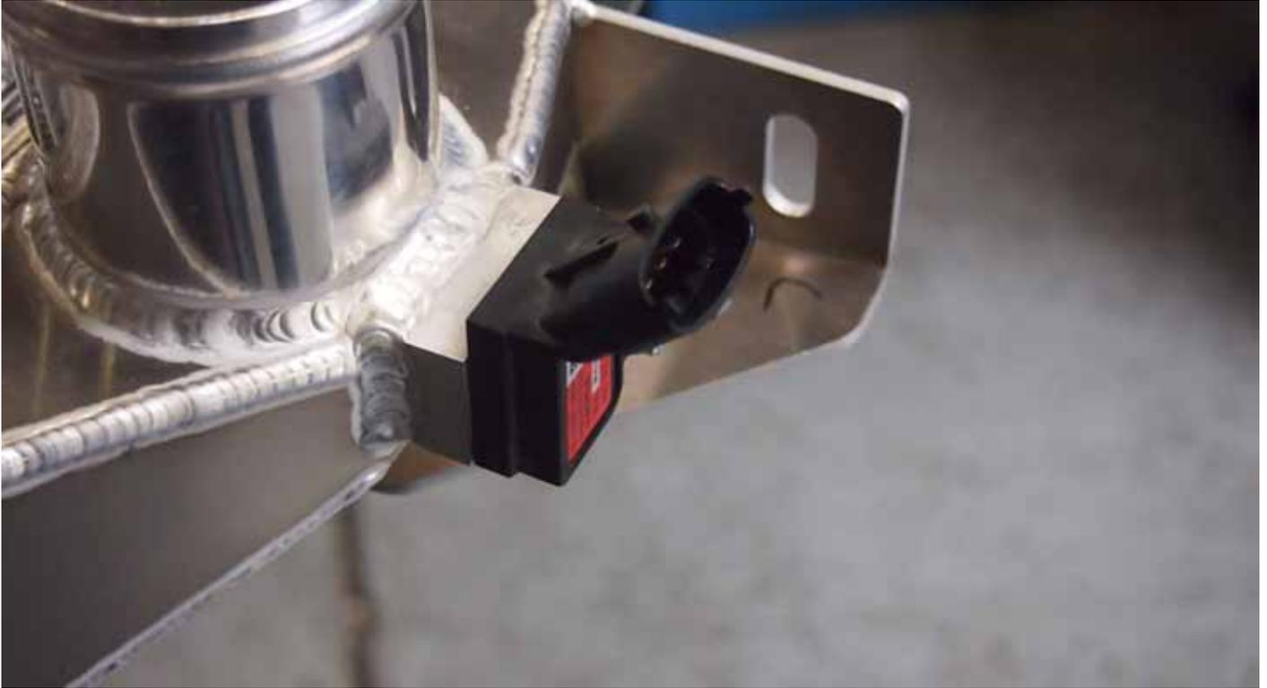
10. Schrauben Sie den neuen Ladeluftkühler mit den mitgelieferten M8 x 20 Schrauben, jeweils einer Unterlegscheibe und den Polystopmuttern an den Halteplatten mit **2 13er Schlüssel** oder einem Schlüssel und einer Knarre fest.
