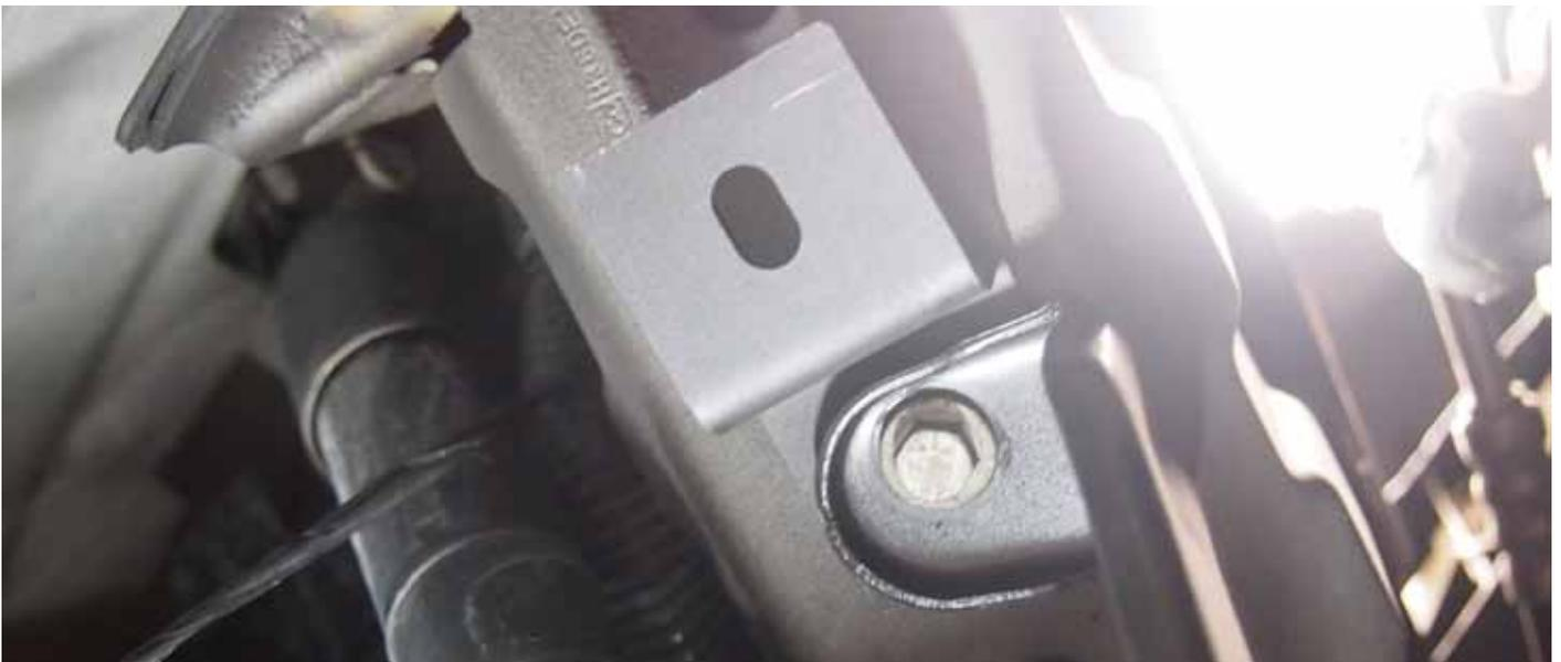
9. Demontieren Sie mit einer **7er Nuss oder Ringschlüssel** den MAP Sensor an dem alten Ladeluftkühler. Dazu schrauben Sie einfach die eine Schraube raus und ziehen vorsichtig den MAP Sensor aus dem Flansch am Ladeluftkühler. Dann setzen Sie den MAP Sensor in den Flansch des neuen Ladeluftkühlers und schrauben ihn mit der originalen Schraube wieder fest oder nutzen die mitgelieferte M5 x 20 Schraube mit einem **4mm Inbus-Schlüssel** (*nur Ford Focus RS500*).
