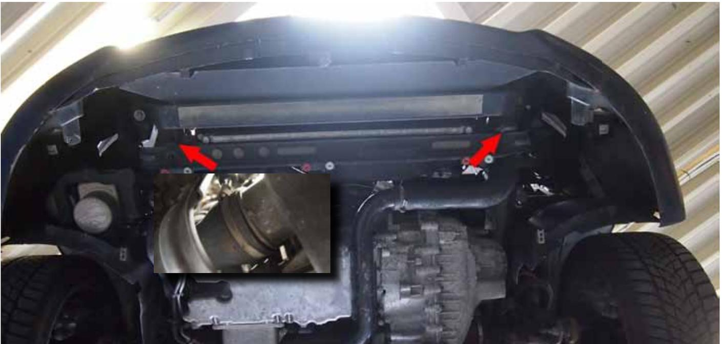
**Hinweis:** Je nach Laufleistung Ihres Fahrzeugs, können die Schellen sowie die Ladeluftschläuche mehr oder weniger festsitzen. Nehmen Sie zum Abziehen der Schläuche vom Ladeluftkühler evtl. einen größeren Schlitzschraubendreher oder ähnliches zur Hilfe. Aber beschädigen Sie weder die Ladeluftschläuche noch die Schellen, da Sie diese weiterverwenden.
