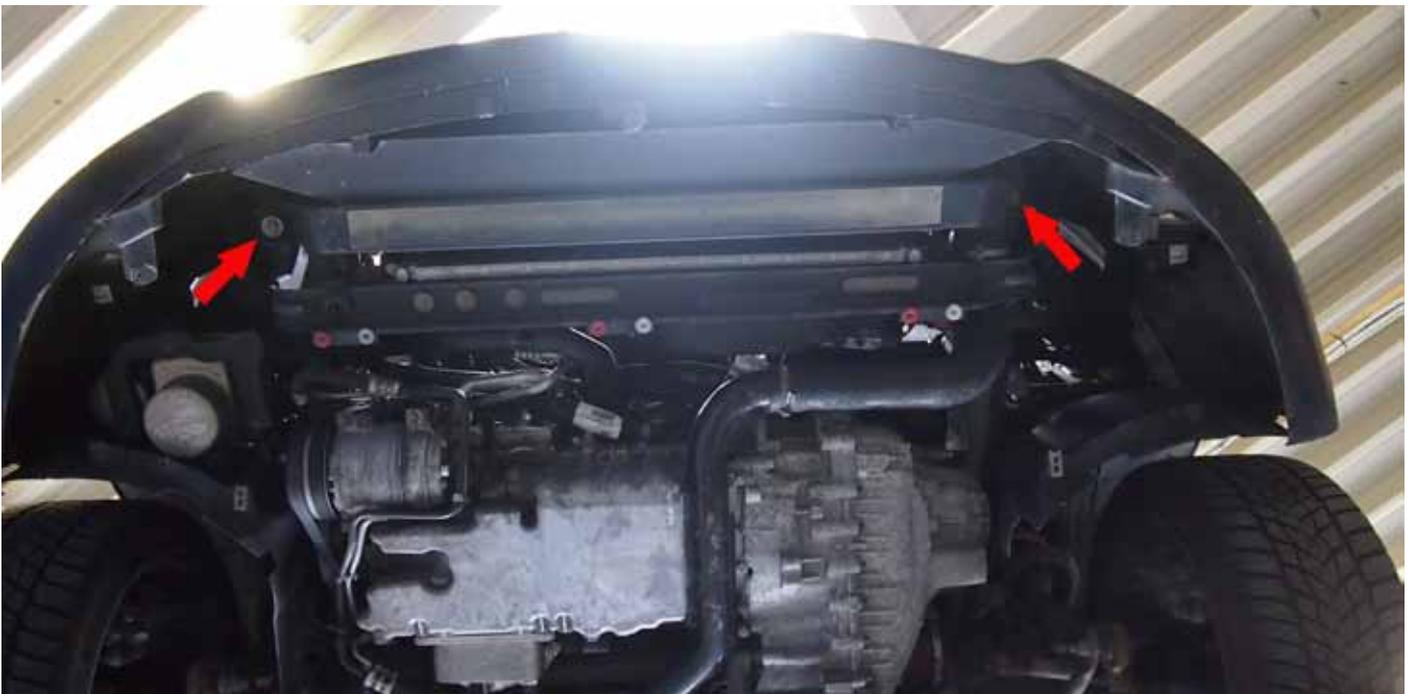
6. Lassen Sie den alten Ladeluftkühler vorsichtig in einer leichten Schräglage nach unten gleiten.
