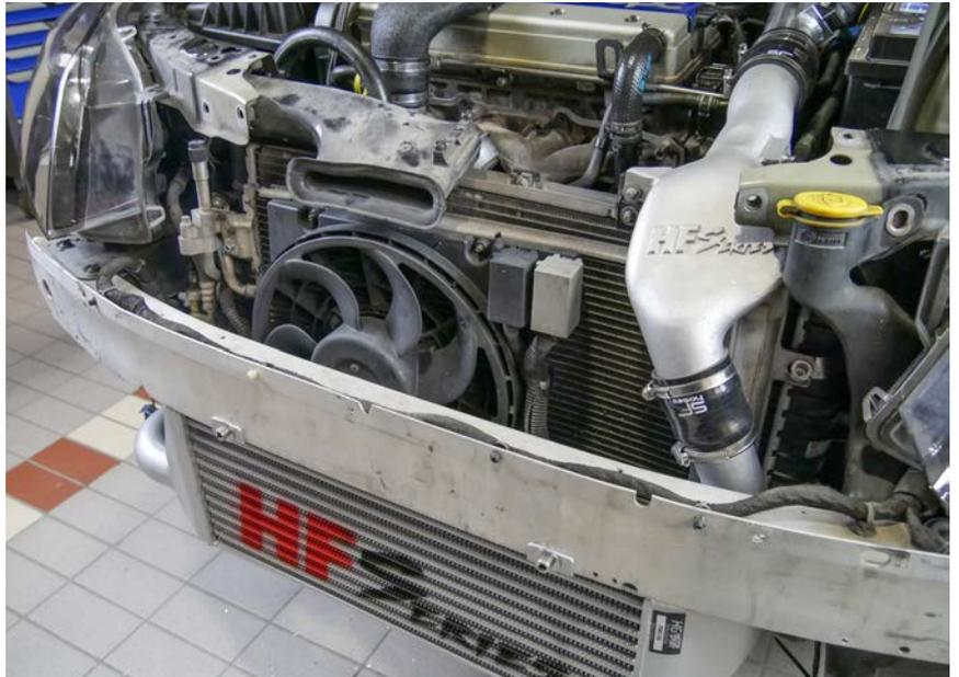
31. Legen Sie den Pralldämpfer der Stoßstange wieder an. Hierbei ist sichtbar, dass die Schrauben, mit denen der Ladeluftkühler befestigt sind ein korrektes Anliegen des Dämpfers verhindern. Bitte schneiden Sie die betreffenden Stellen aus.
