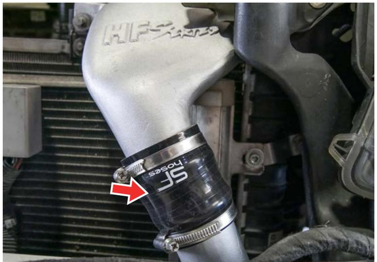
30. Befestigen Sie das Druckrohr mit dem Mapsensorrohr, indem sie den mitgelieferten SF-hoses Schwingungsdämpfer benutzen. Ziehen Sie nach der Montage die Schellen fest.
