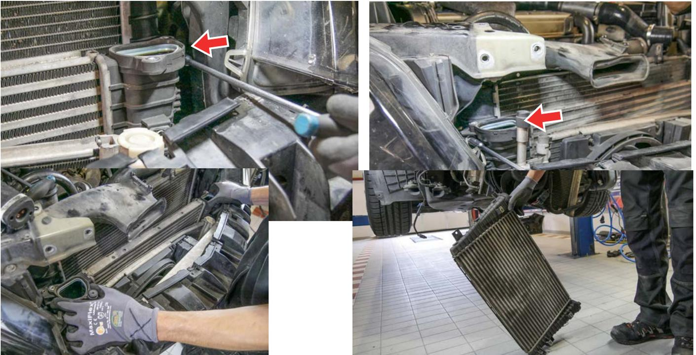
20. Bitte befestigen Sie den Klimakühler jetzt wieder mit dem mitgelieferten Versatzkit (Haltersatz) am Wasserkühler, denn der HF-Series Ladeluftkühler wird vor dem Klimakühler montiert. **Beachten Sie bitte, dass Sie beim Anschrauben eine der Serienschrauben benötigen, die sie beim Abschrauben des Klimakühlers entfernt haben.**
