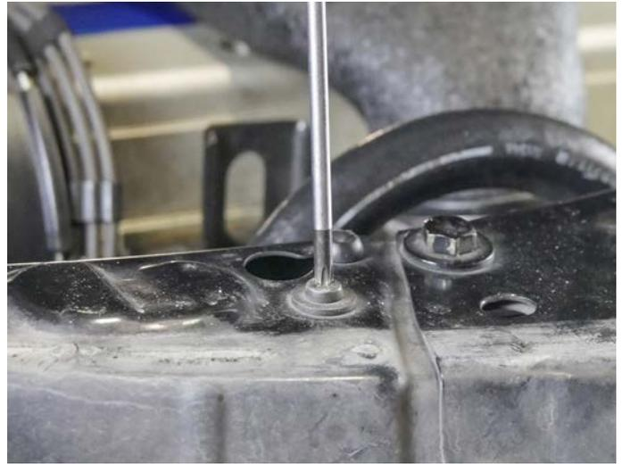
11. Der Ansaugstutzen ist in der Mitte noch in einer Haltenase befestigt. Lösen Sie ihn deshalb dort noch hinaus.
