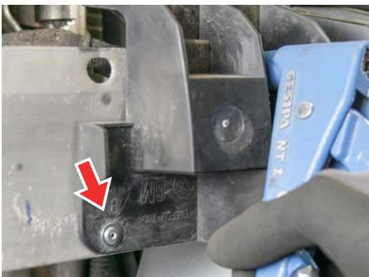
33. Montieren Sie in umgekehrter Reihenfolge den Schlossträger (inkl. Einlass vom Scheibenwischwasser), Schürze, Schlauch vom Scheibenwischwasser am Unterboden, Kabel von den Nebelscheinwerfern und die 3 Befestigungsschrauben am Unterbodenschutz.
