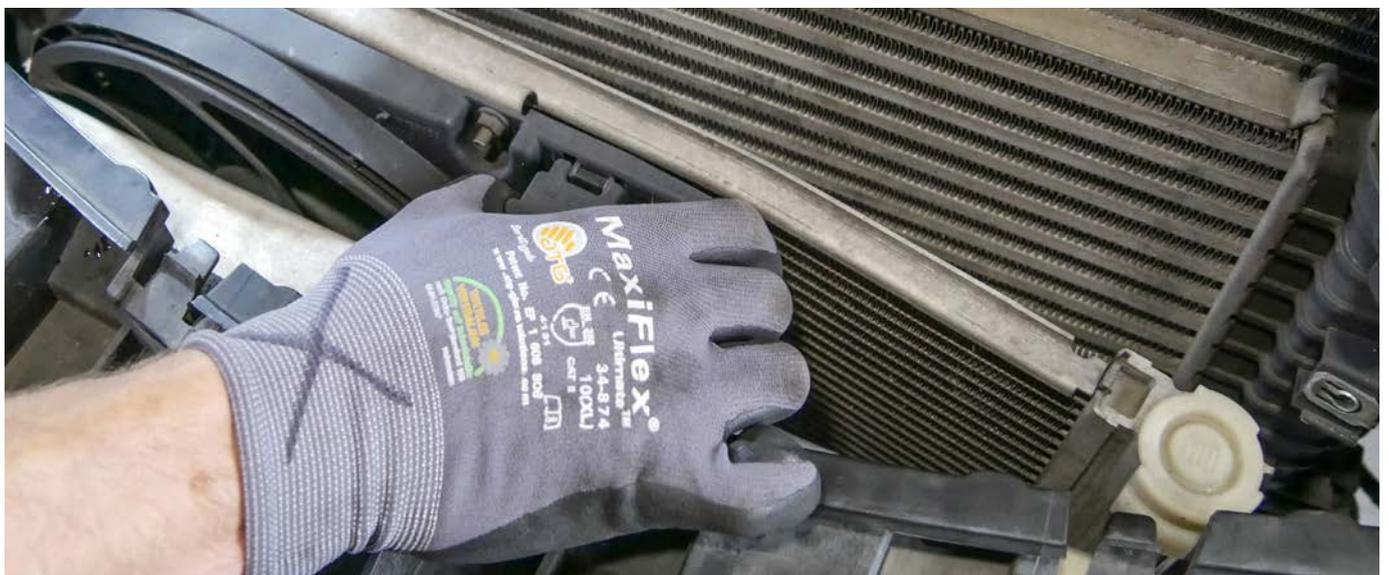
19. Bei dem Ladeluftkühler müssen zuerst noch die Schrauben entfernt werden (Torx Nuss E8). Danach den Ladeluftkühler ein Stück nach oben aus der Halterung ziehen um ihn dann runter wegzuziehen um ihn aus dem Wagen zu entfernen.
