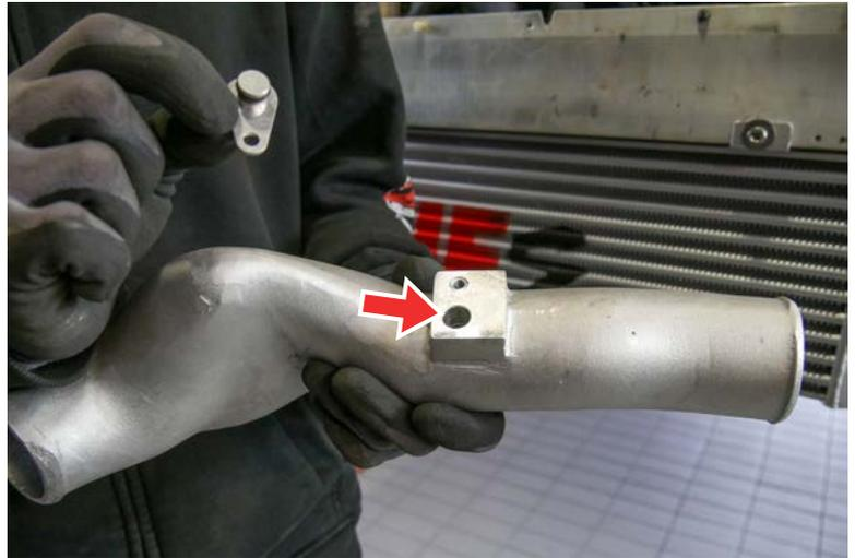
29. Danach verbinden Sie das Druckrohr mit dem Ladeluftkühler. Dazu wird der mitgelieferte SF-hoses Reduzierer und 2 Schellen benötigt.
