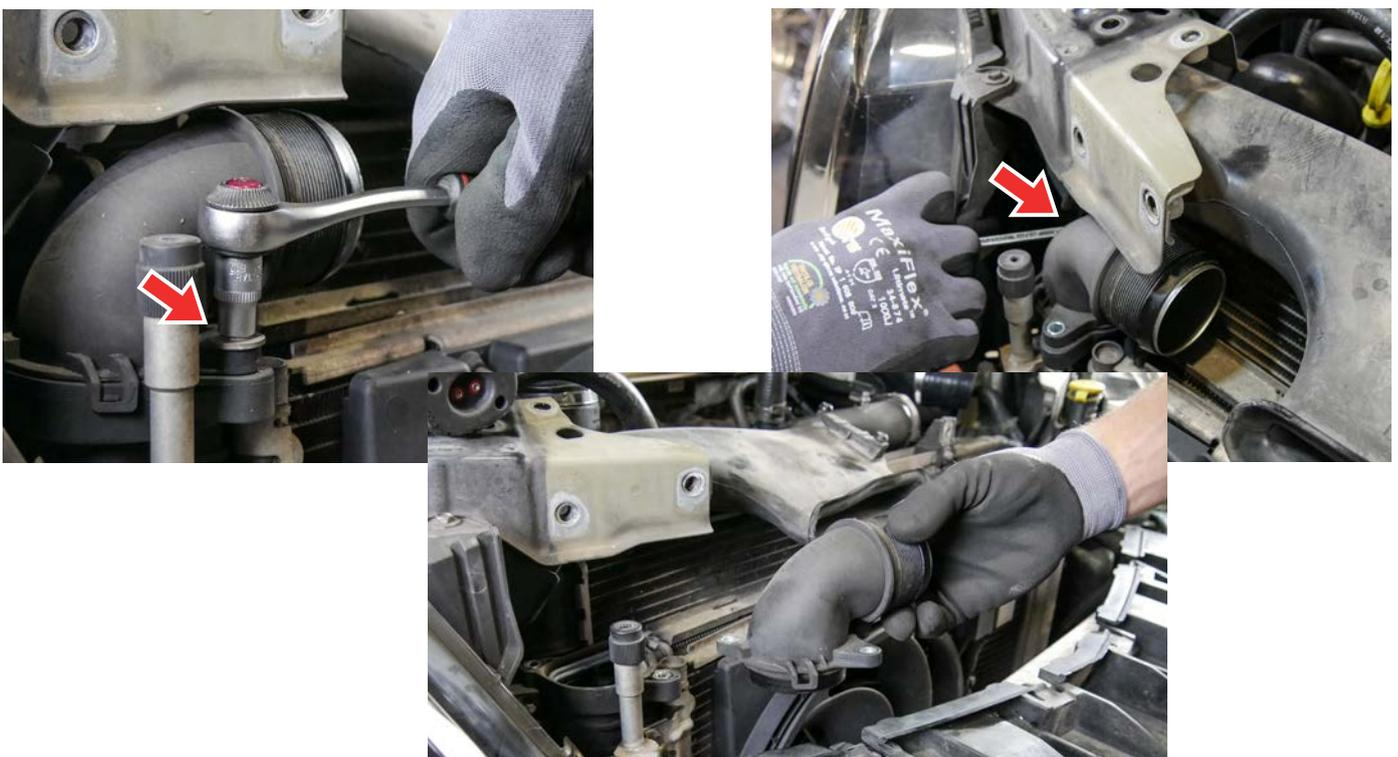
17. Lösen Sie mit einem Torx E8 sämtliche Schrauben, die den Klimaanlagekühler festhalten.
