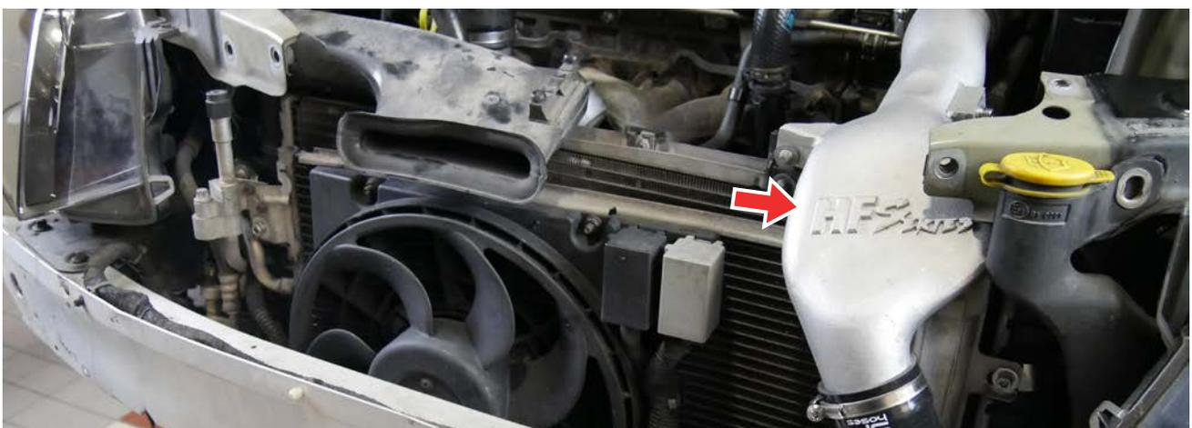
28. Vorweg bringen Sie den mitgelieferten Verschlussstopfen an das Druckrohr an und fixieren es mit einer Schraube. Achten Sie auf den korrekten Sitz des Dichtrings.
