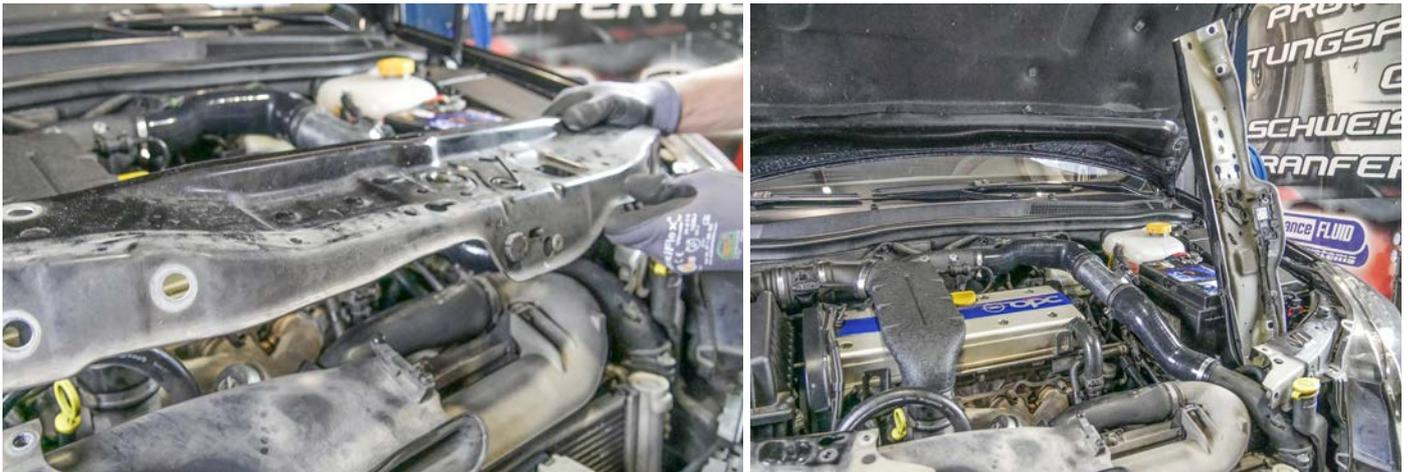
14. Lösen Sie die Schelle vom Druckrohr (mit Torx Nuss E8) und entfernen Sie dieses.
