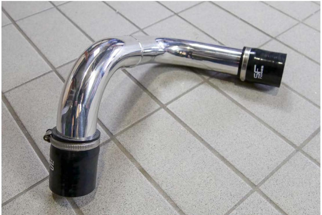
26. Bitte stecken Sie nun das fertig montierte Druckrohr inkl. SF hoses Silikonverbinder in die Aussparung am Unterboden. Befestigen Sie den oberen Teil am Turboladerauslass. Danach befestigen Sie den unteren Silikonverbinder mit dem Ladeluftkühler und ziehen die Schellen fest.
