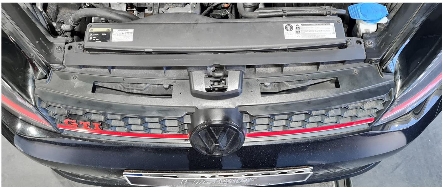
5. Bauen Sie nun die Luftleitbleche ein und befestigen diese, mit den dazugehörigen Schrauben.
