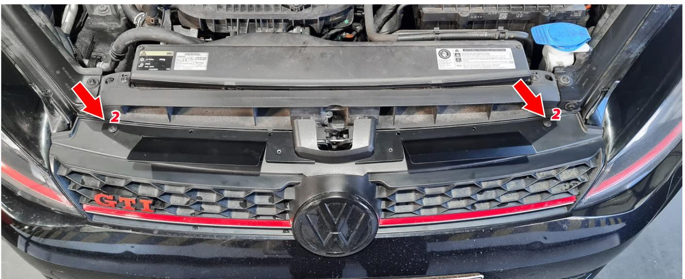
2. Schrauben Sie die mitgelieferten T20 Torxschrauben in die Mittleren beiden Löcher in den Luftleitblechen, um diese mit dem Kühlergrill zu befestigen. (Wenn Sie vorbohren möchten, nutzen sie einen 2mm Bohrer)
