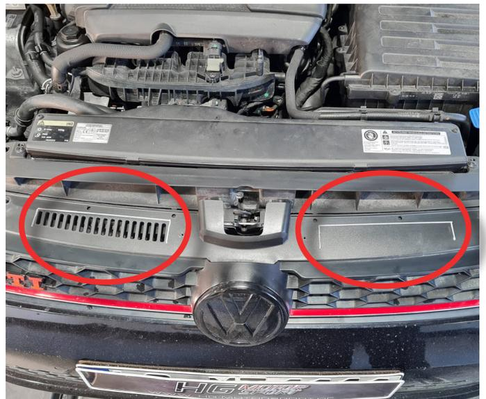
4. Schneiden Sie nun die angezeichneten Flächen aus. Bauen Sie den Kühlergrill anschließend wieder ein.
