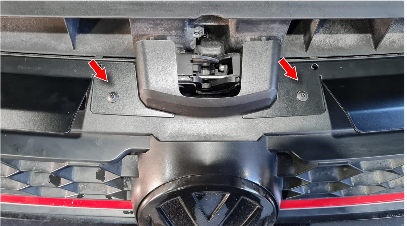
3. Markieren Sie die auszuschneidenden Flächen mittels Permanentmarker und bauen Sie anschließend den Kühlergrill nach Herstellervorgabe aus.
