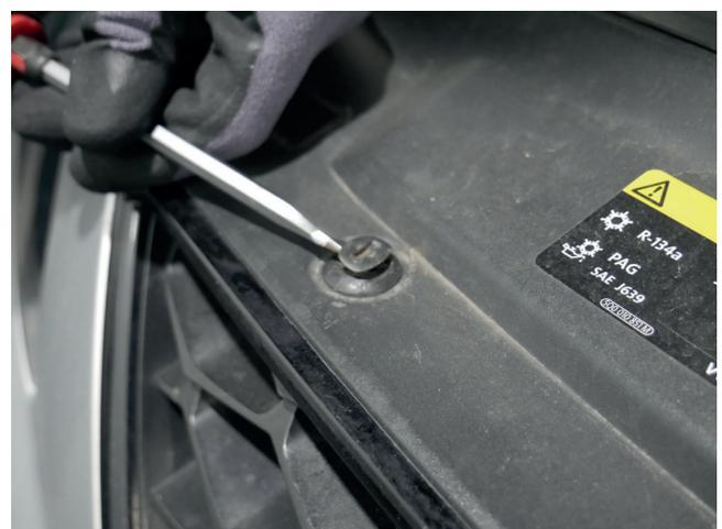
2. Ziehen Sie die hintere Kante der Abdeckung vorsichtig nach oben um so die obere Abdeckung des Schlossträgers aus dem Fahrzeug zu entfernen.
