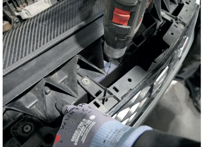
5. Wenn Sie die beiden Löcher des entsprechenden Luftleitblechs gebohrt haben, können Sie das Luftleitblech mit den mitgelieferten Grobgewindeschrauben an der Frontmaske fixieren. Wiederholen Sie die Arbeitsschritte entsprechend für die andere Seite.
