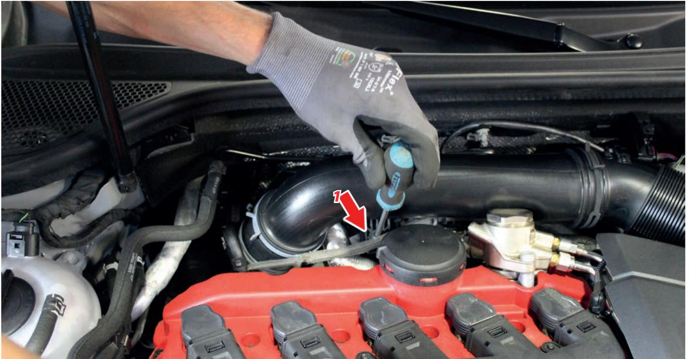
3. Gleiches machen sie bei der **T30 Torx-Schraube (2)** unmittelbar hinter der Benzinpumpe. Auch hier ist Fingerspitzengefühl gefragt. Nehmen Sie sich sonst, sofern vorhanden, einen Magnethalter zur Hilfe.
