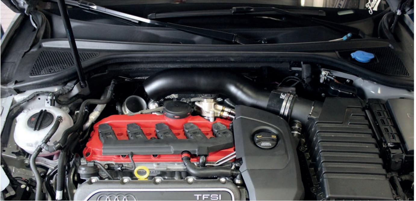
10. Montieren Sie nun den **89 auf 76mm-Silikonreduzierer 45° (1)** samt der dementsprechenden Schlauchschellen zwischen dem HF Series Air Intake und dem Turbolader.
