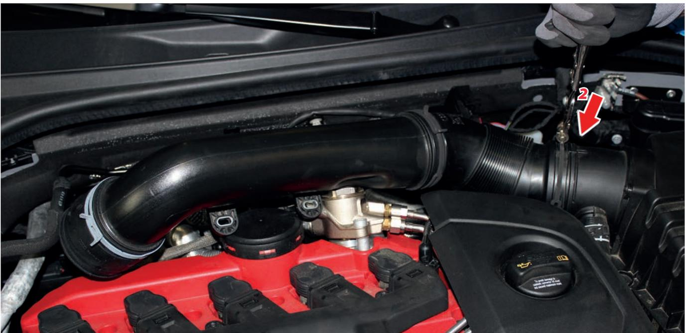
6. Entfernen Sie nun komplett das originale Ansaugrohr aus dem Motorraum.
