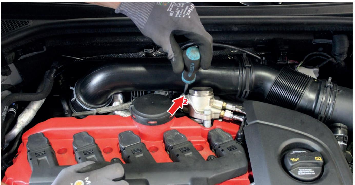
4. Lösen Sie mit einer Schlauchschellen-Zange oder alternativ einer Wasserpumpenzange die **Schlauchschellen (1)** am Ende des Ansaugrohrs. Ziehen Sie die Schlauchschellen soweit von der Verbindung ab, dass Sie hinterher das Ansaugrohr vom Turbolader abziehen können.
