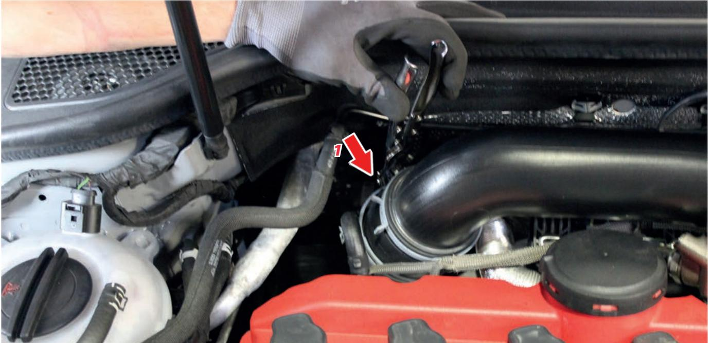
5. Öffnen Sie nun die **Schlauchschelle (2)**, welche sich an dem Ende des Ansaugrohrs zum Luftfilterkasten befindet. Ziehen Sie dann das originale Ansaugrohr vom Einlassstutzen.
