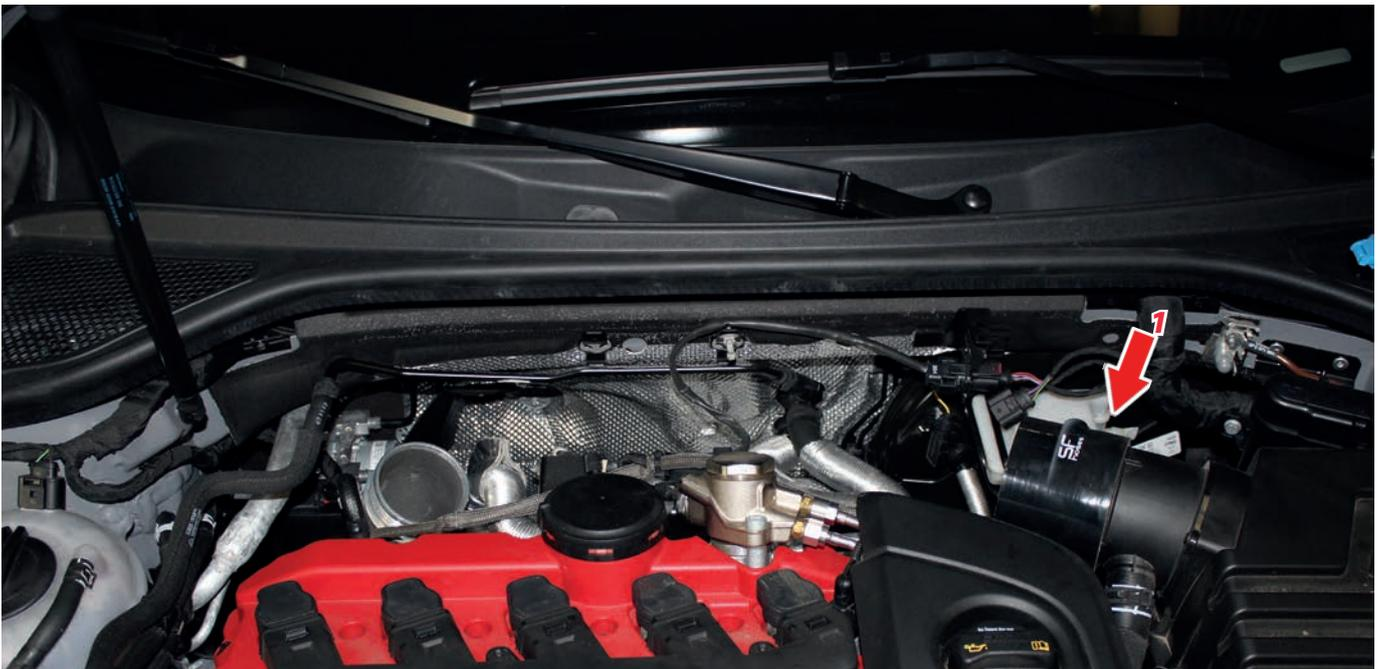
9. Platzieren Sie das HF-Series Air Intake wie gezeigt in den Schwingungsdämpfer und ziehen die Schlauchschellen soweit fest, dass Sie das Rohr noch drehen und in der Position justieren können.
