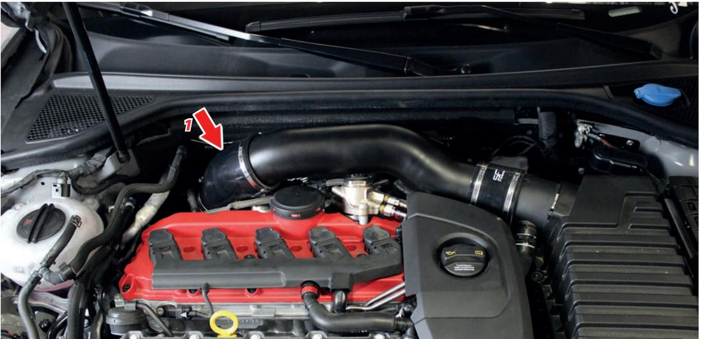
11. Prüfen sie jetzt nochmal den korrekten Sitz des HF Series Air Intakes, der Silikonteile und der Schellen. Sofern nichts anschlägt, scheuert oder die Funktion eines anderen Bauteils nicht beeinträchtigt, ziehen Sie alle Schellen mit einem 7er-Ring- oder Maulschlüssel fest, alternativ mit einer Ratsche und dementsprechender Nuß oder einem T-Griff.
