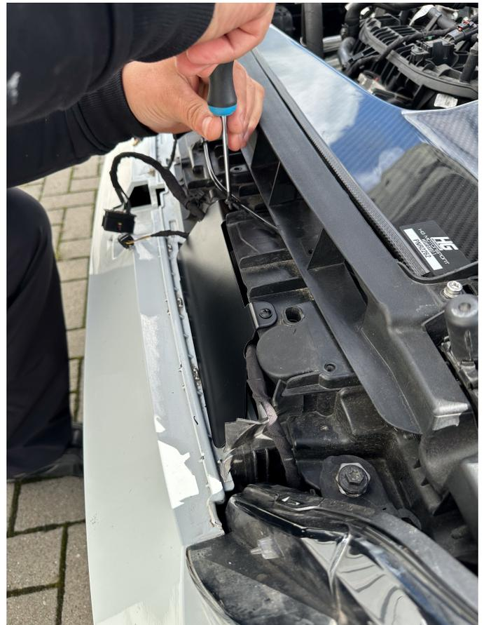
**Hinweis: Um eine optimale Luftführung zu gewährleisten ist es erforderlich den serienmäßigen Frontgrill auszuschneiden. Nutzen Sie dafür geeignetes Werkzeug.**
