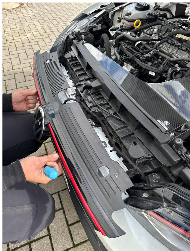
3. Entfernen Sie die serienmäßigen Kabelverbindungen vom Frontgrill.
