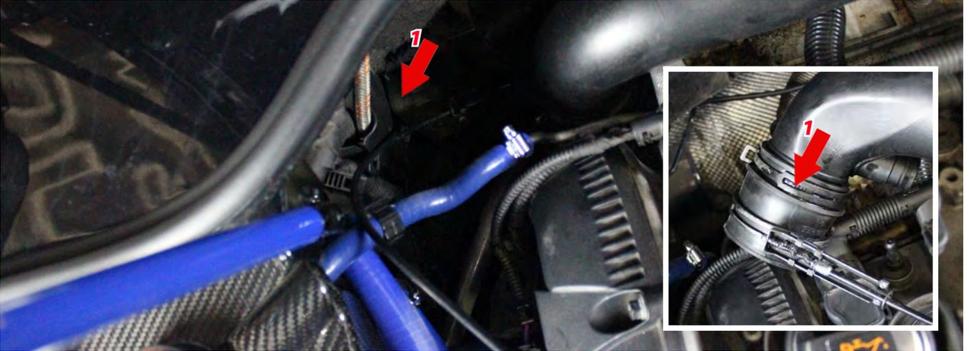
16. Entfernen Sie den **Schlauch der Kurbelwellengehäuseentlüftung (2)** durch Zusammendrücken des Klemmrings.
