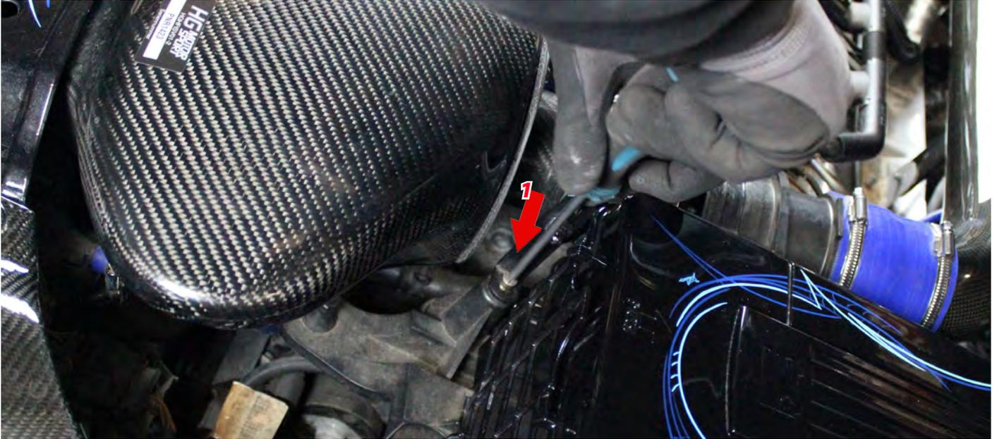
28. Montieren Sie die Motorabdeckung wieder mit leichtem Druck auf den Haltenasen, bis diese in der Motorabdeckung einrasten.
