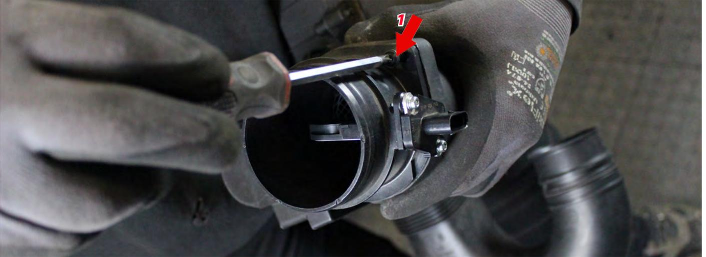
13. Lösen Sie links und rechts die Schrauben, mit denen die Luftsammler-Aufnahme am Schlossträger fixiert ist.
