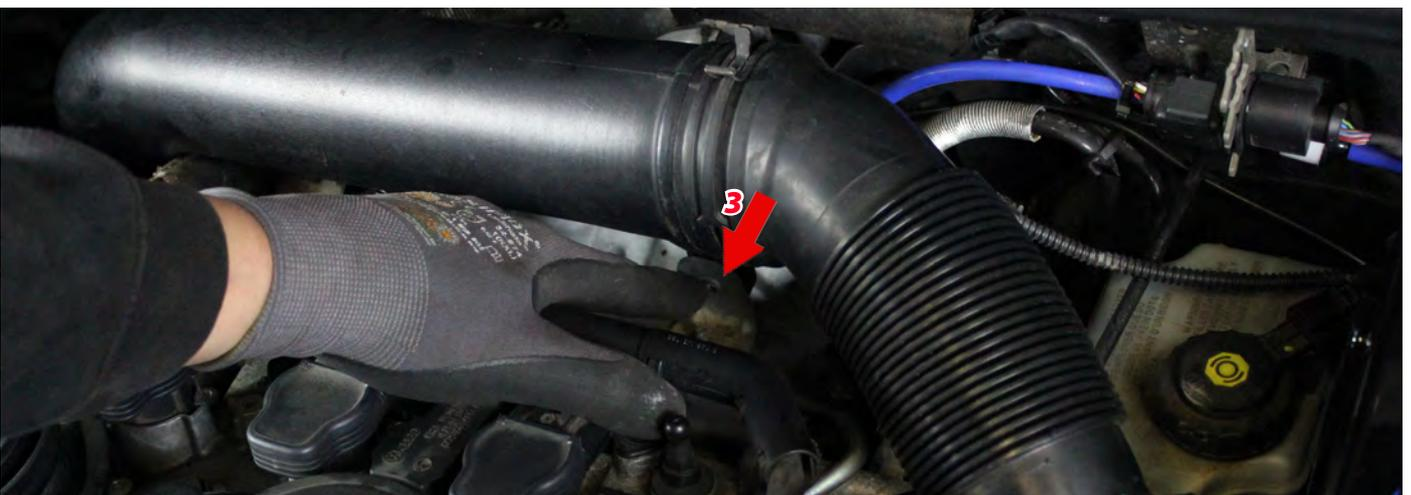
15. Entfernen Sie die **Klemmschelle (1)** zwischen Ansaugrohr und Turbolader. Dies machen Sie idealerweise mit einer Schellen-Zange mit entsprechender Welle o. ä.
