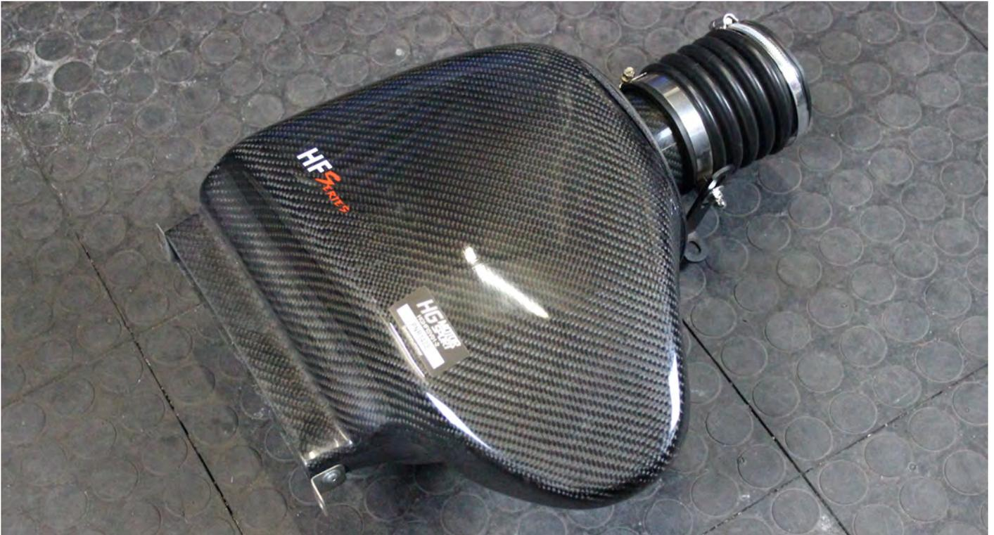
25. Drücken Sie den Schwingungsdämpfer an der Airbox in der Längsrichtung zusammen, so dass Sie die Airbox zwischen Ansaugrohr und Lufteinlass im Schlossträger platzieren können. Ziehen Sie dann die Haltewinkel mit den T25 Torx Schrauben am Schlossträger bzw. Lufteinlass fest.
