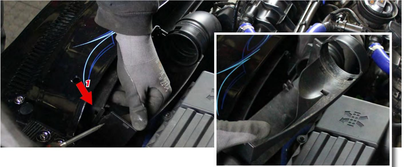
11. Entfernen Sie den Luftfilterkasten durch behutsames Ziehen. Der leichte Widerstand ist basierend auf den zwei **Haltenasen (2)**, welche sich auf der Unterseite des Luftfilterkastens befinden.
