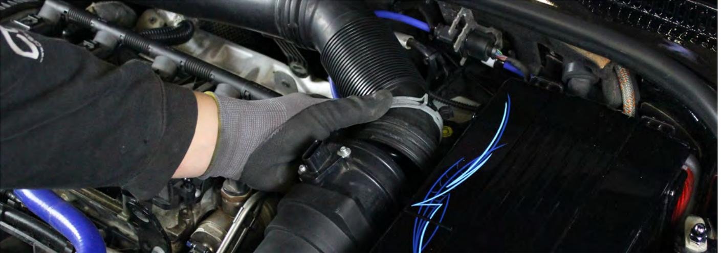
7. Drehen Sie die **Inbus-Schrauben (1)** heraus, mit denen der Luftfilterkasten im Motorraum befestigt ist.
