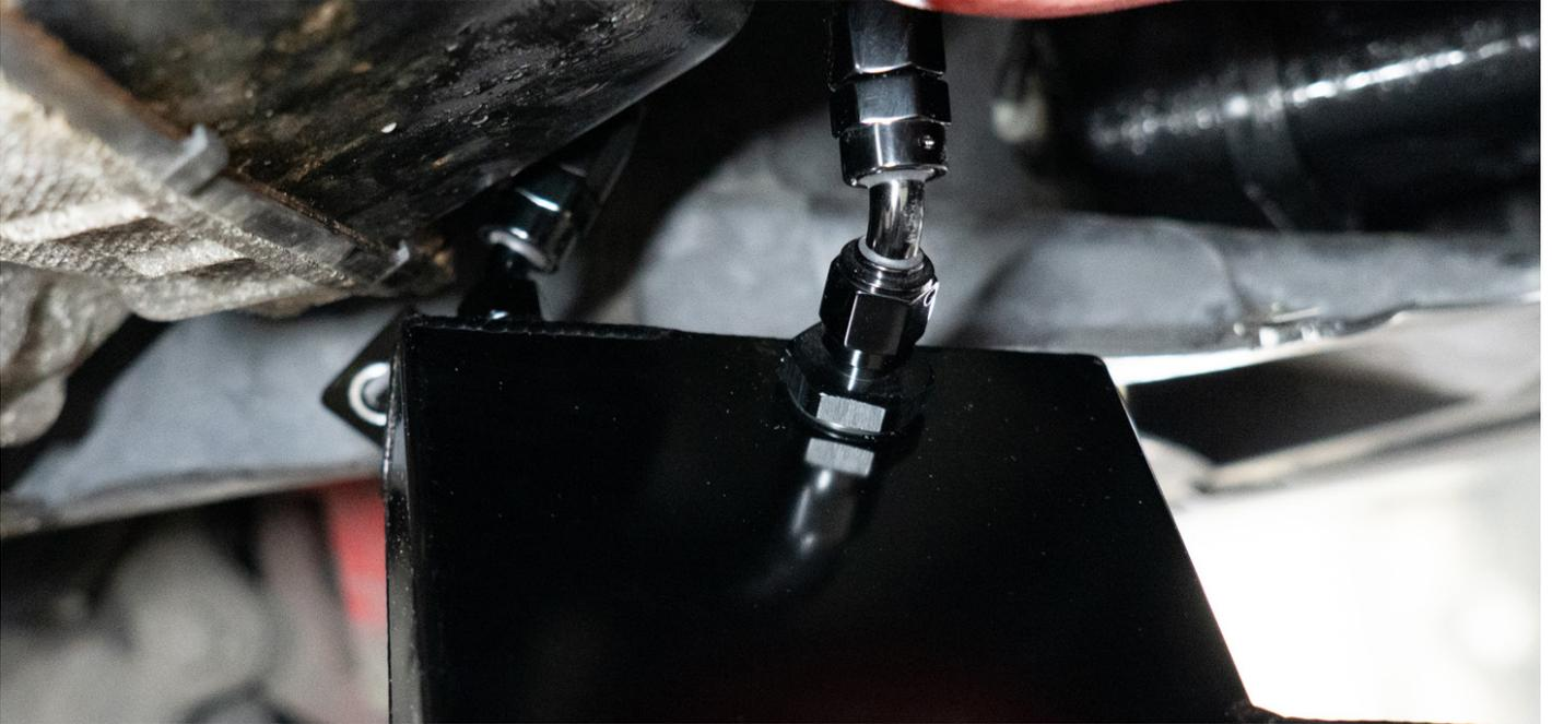
12. Montieren Sie die CatchCan neben dem rechten Ladeluftkühlerschlauch, mittels zweier Schrauben (M6 & M8), wie auf den Bildern zusehen.
