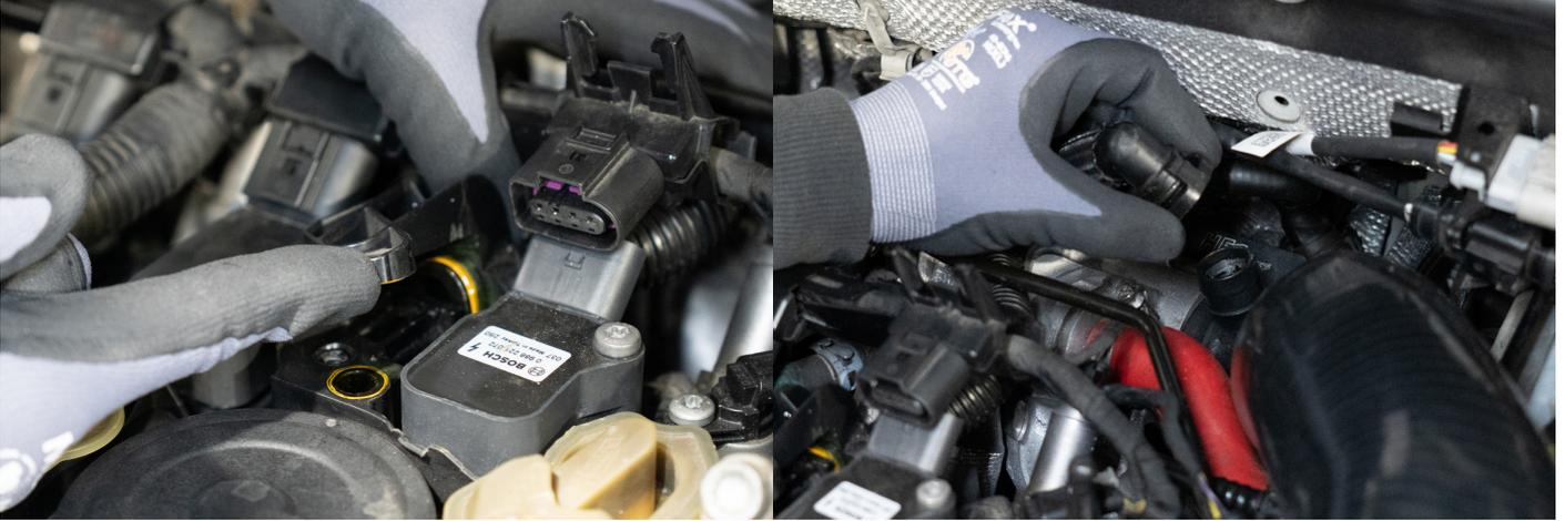
3. Entfernen Sie die sieben T30 Schrauben der PCV Platte wie gekennzeichnet.
