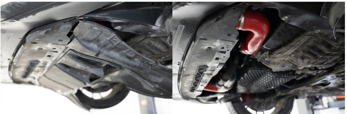
10. Führen Sie den ersten Schlauch vom Turboinlet in Richtung Unterboden und montieren diesen an der Oberseite der Catchcan.
