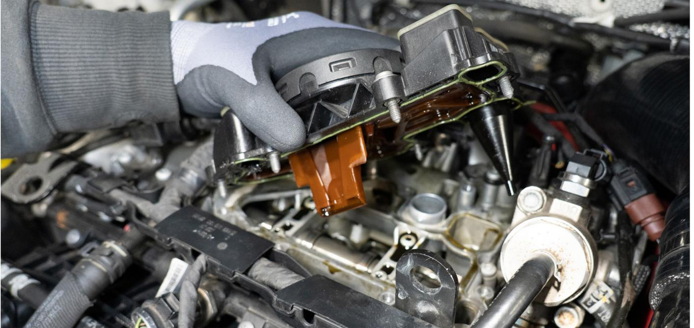
6. Übernehmen Sie die original Dichtung und setzen diese in die austausch PCV-Platte des CatchCan Systems.
