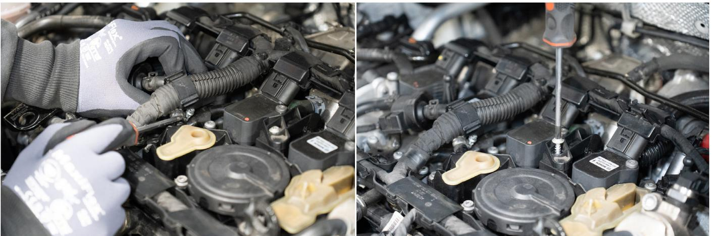
2. Demontieren Sie die Leitung der Kurbelgehäuseentlüftung, wie auf den Bildern zusehen.
