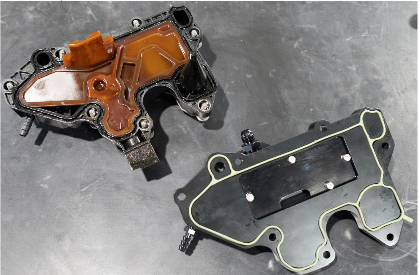
7. Montieren Sie die austausch PCV-Platte des CatchCan Systems, in umgekehrter Reihenfolge zur Demontage.
