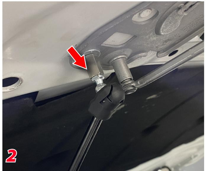
5. ACHTUNG! Entfernen Sie den serienmäßigen Motorhaubenhalter, bevor Sie die Motorhaube schließen, um Schäden am Fahrzeug zu vermeiden.
