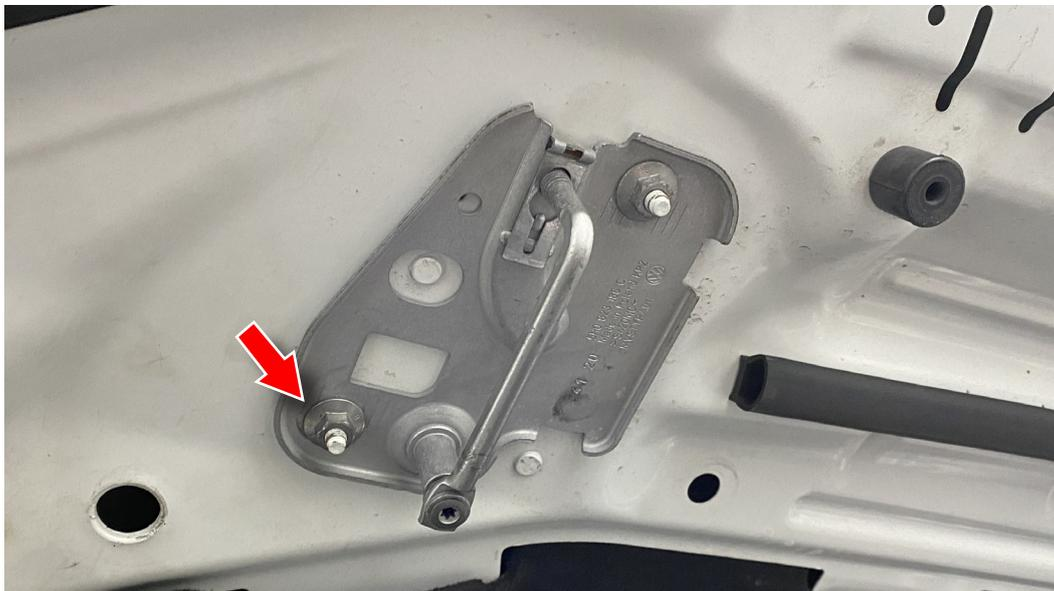
3. Montieren Sie den mitgelieferten gewinde Kugelkopf, zusammen mit der Unterlegscheibe (Siehe Bild) und ziehen diesen mit 20Nm fest.(10er Nuss)
