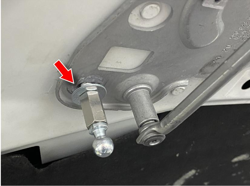
4. Montieren Sie den HG Motorsport Motorhaubenlift an dem vorhandenen Kugelkopf(rechts über dem Kühlwasserbehälter)(Bild 1) & an dem zuvor montierten Kugelkopf an der Motorhaube.(Bild 2)
