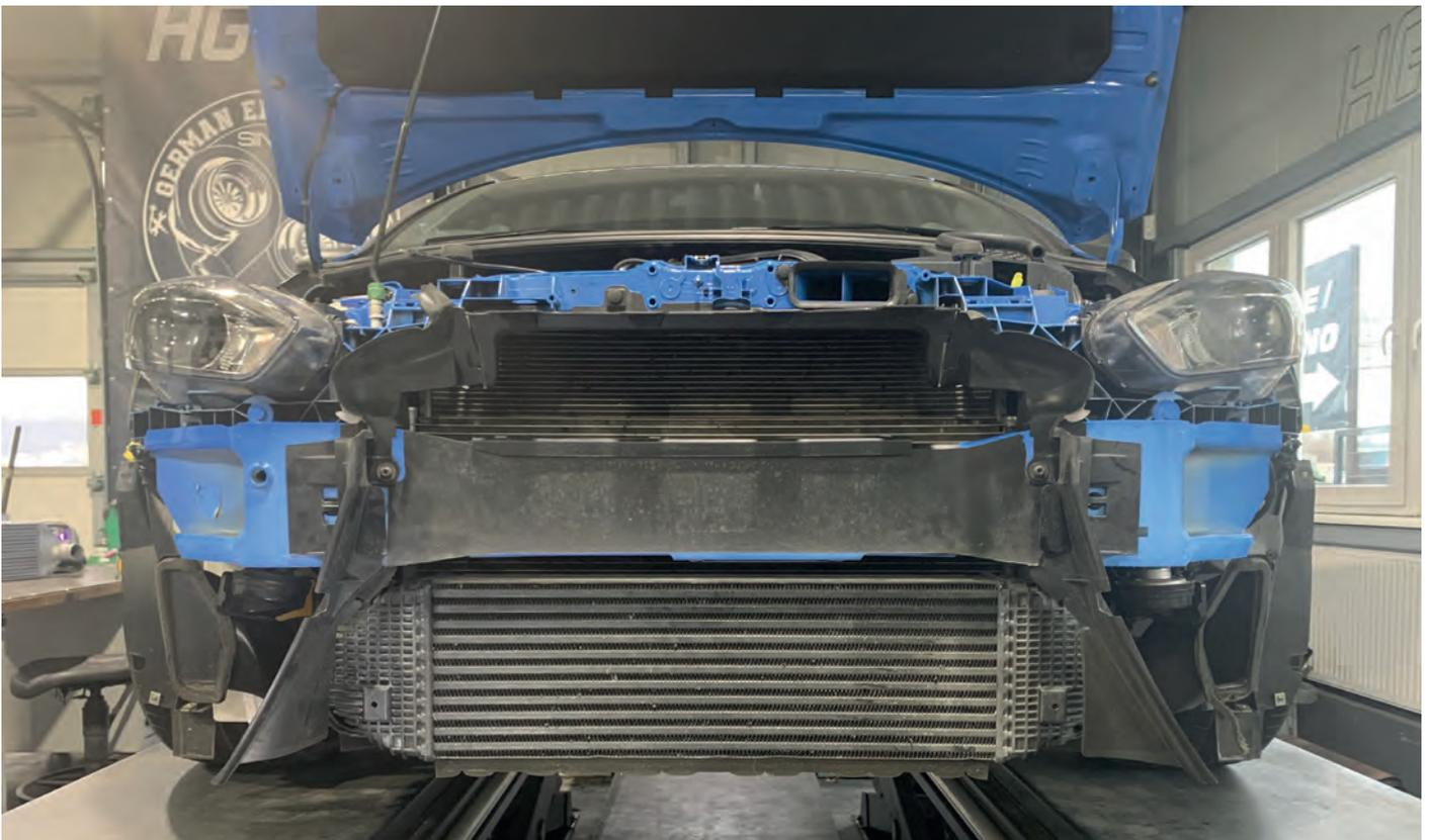
2. Demontieren Sie die Plastikverkleidung mit einem TX-30 Torxschraubendreher.
