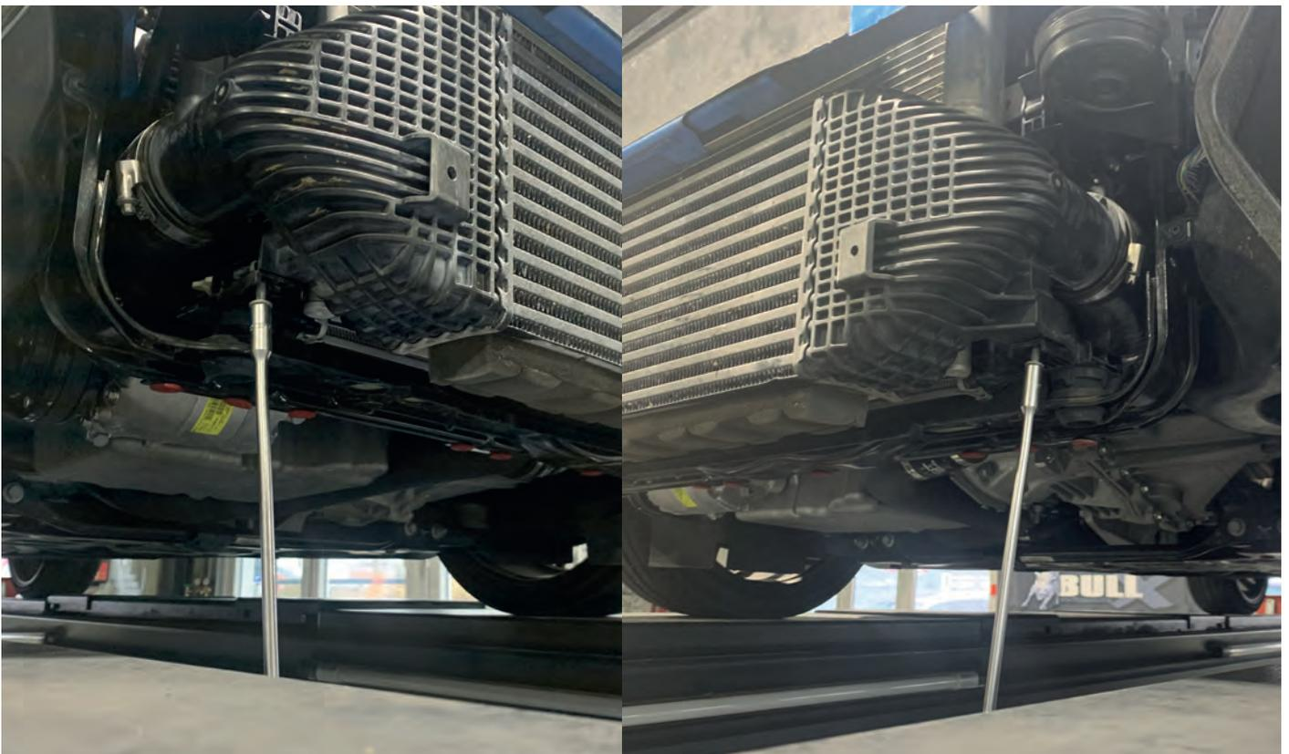
4. Lösen Sie die Schlauchschellen am Ladeluftkühler, mit einer 7mm Nuss.
