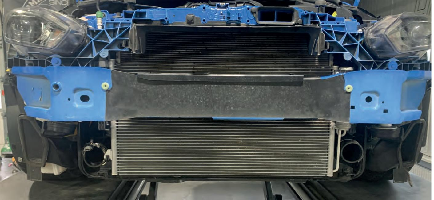
7. Entfernen Sie den MAP Sensor aus dem serienmäßigen Ladeluftkühler und bauen Sie diesen in den HF-Series Ladeluftkühler.
