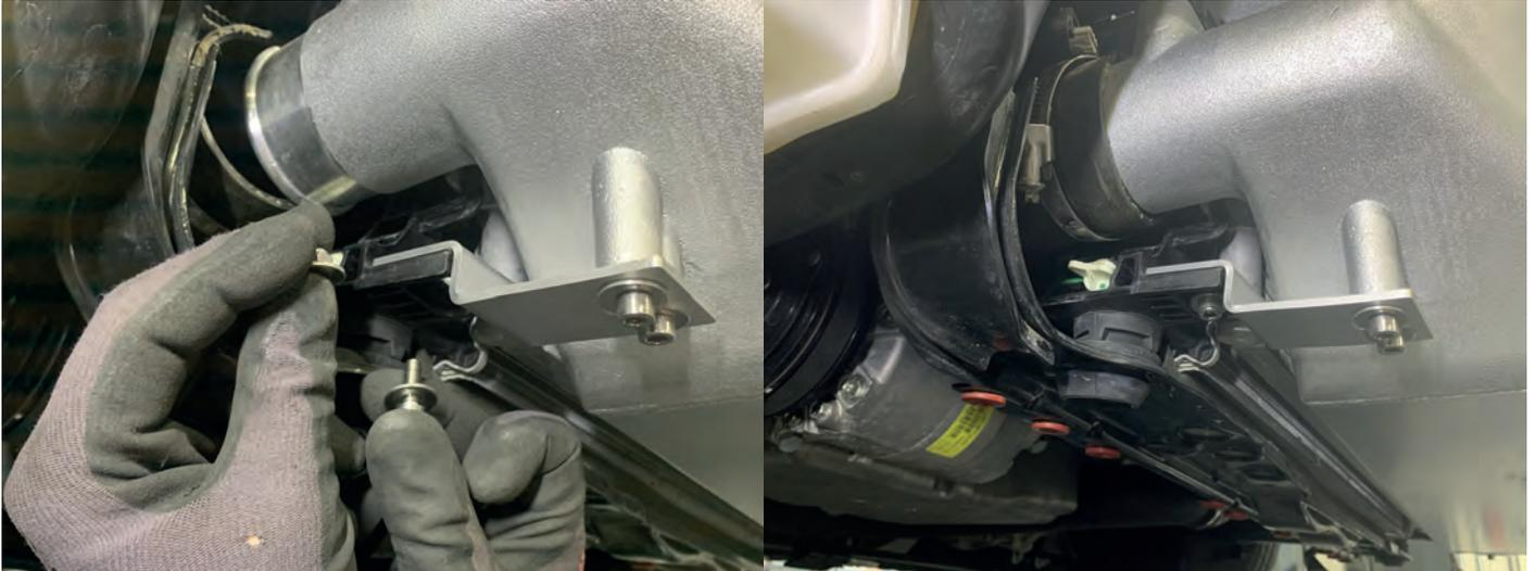
12. Montieren Sie nun die Ladeluftschläuche am Ladeluftkühler & befestigen Sie diese mit den serienmäßigen Schlauchschellen.
