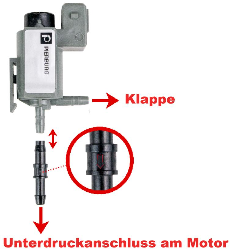
13. Montieren Sie das Magnetventil an geeigneter Stelle im Motorraum und Verlegen Schlauch und Kabel in dessen Richtung.
