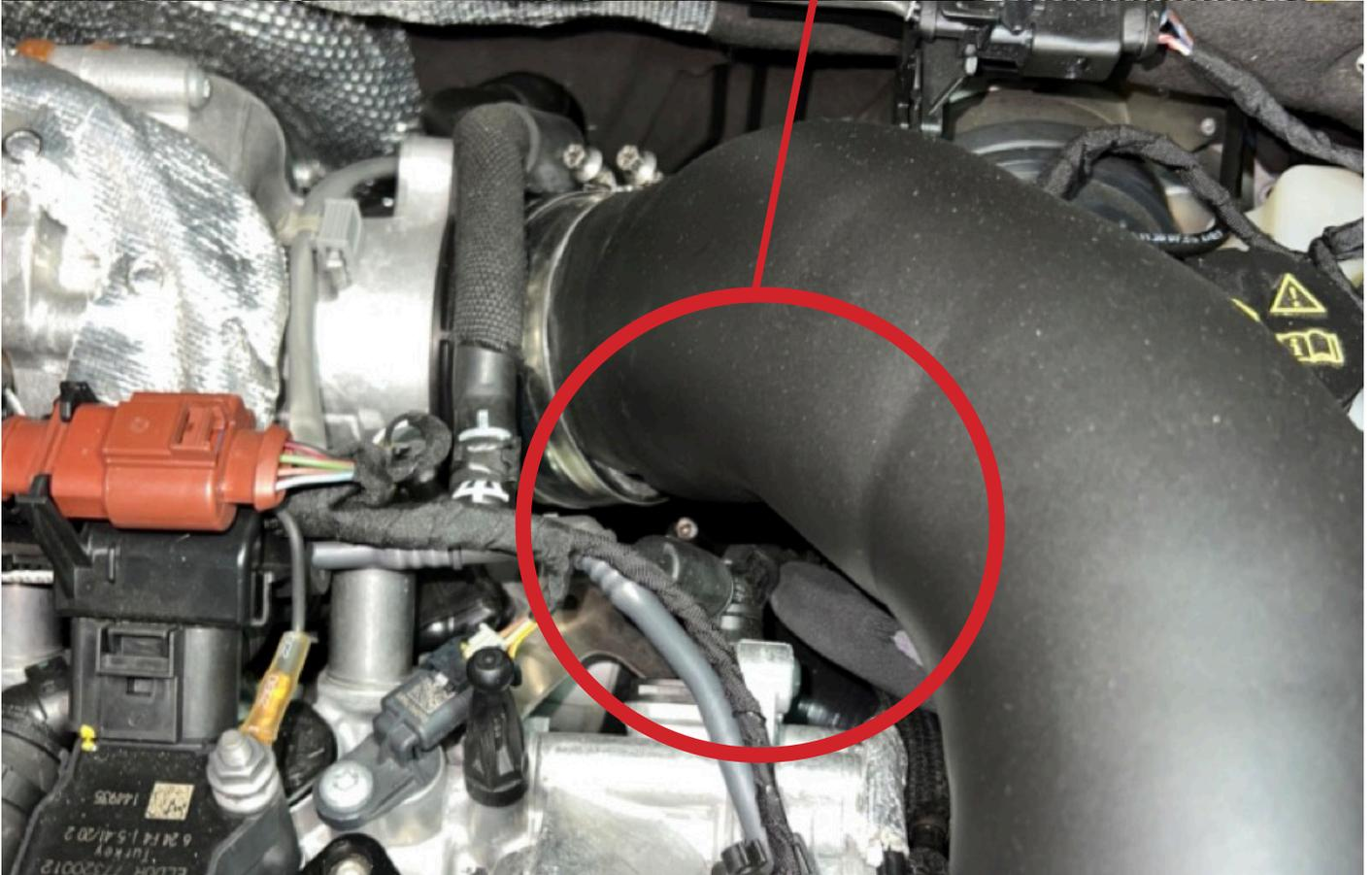
12. Montieren Sie nun in die Leitung zum Magnetventil, das Rückschlagventil (bitte Pfeilrichtung beachten siehe Bild).
