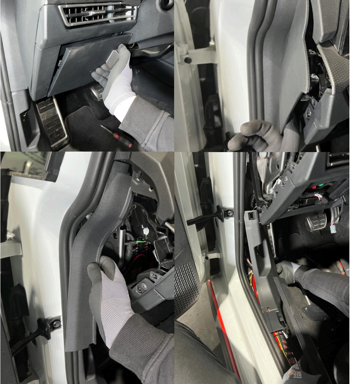
4. Das Can Gateway befindet sich an der Lenksäule, entfernen Sie den Abgebildeten Stecker vom CAN Gateway durch Lösen des Verriegelungshebels und ziehen die Pin Leiste wie ersichtlich aus dem Gehäuse.
