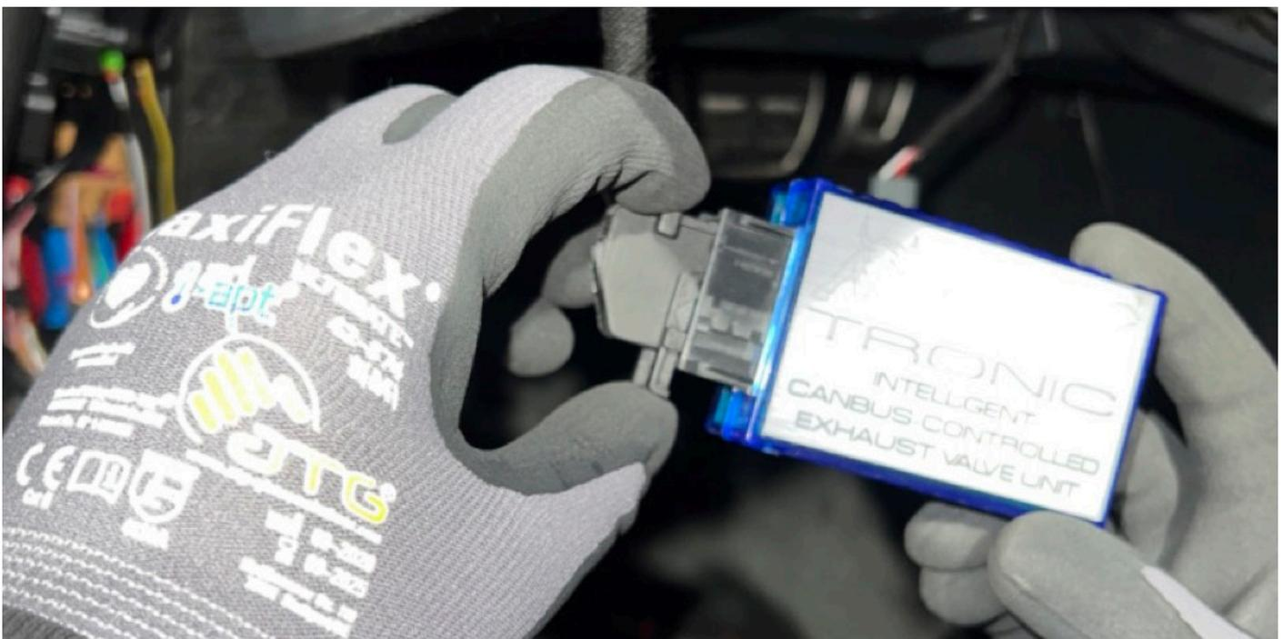
Ab diesem Punkt darf auf keinen Fall die Zündung eingeschaltet werden, da es sonst zu einem Kurzschluss am Kabel zum Magnetventil kommen kann.
