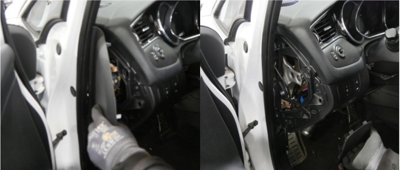
2. Die Stromversorgung (+) der Bull-X-Tronic, nehmen Sie am Sicherungskasten(MF35) oben rechts ab.
