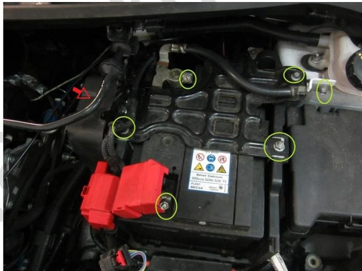
**Schritt 5:** Drehen Sie die drei Schrauben heraus und lösen Sie die beiden Stecker des Steuergerätes. Nun entnehmen Sie die Batteriebox samt Steuergerät.
