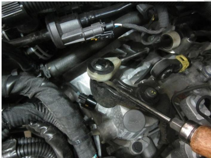
**Schritt 7:** Ziehen Sie das Taktventil nach oben aus der Halterung und legen es unterhalb der Halterung um Platz für das Abziehwerkzeug zu schaffen.
