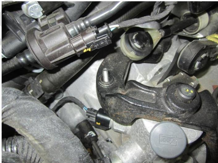
**Schritt 10:** Stecken Sie die Schaltwegverkürzung nur auf und drehen sie die Schraube von unten fest. Anschließend die seitlichen Inbusschrauben fest anziehen (rote Pfeile). Auch den Kugelanschluss nochmals etwas nach ziehen (grüner Pfeil).
