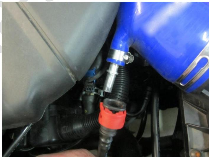
**Schritt 3:** Klemmen sie den Stecker des Luftmassenmessers ab. Den Ansaugstutzen müssen Sie nach hinten lösen und die Airbox nach oben heraus nehmen.
