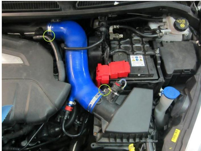
**Schritt 2:** Klemmen Sie den Anschluss der Entlüftung ab. Entnehmen Sie nun den Ansaugschlauch und legen ihn zur Seite.
