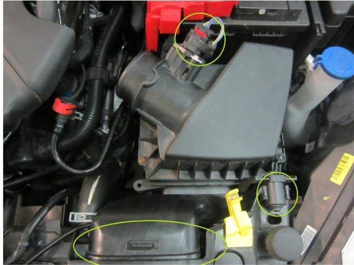
**Schritt 4:** Lösen Sie nun die gekennzeichneten Schrauben und entnehmen Sie die Batterie. An der Seite befindet sich eine Kunststoffabdeckung des Steuergerätes. Diese ist oben mit einem Clip befestigt (Rot gekennzeichnet). Diesen mit einem Kreuzschraubenzieher herausdrehen und die Abdeckung nach oben entnehmen.
