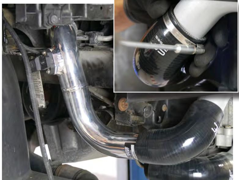
12. Das untere Druckrohr wird vom originalen Silikonschlauch getrennt und durch das neue Druckrohr von HF-Series ausgetauscht. Beachten Sie bitte den Halter neben der Öl-Wanne.
