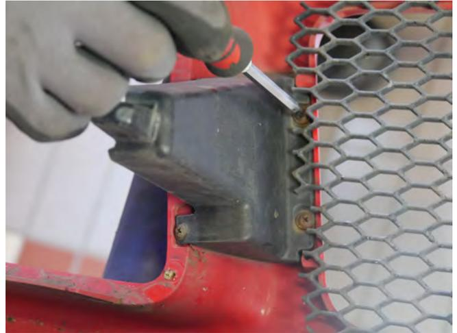
13. Damit die Stoßstange wieder verbaut werden kann, muss diese nun bearbeitet werden. Im ersten Schritt dazu werden die Gitter entfernt. Auf der linken Seite (in Fahrtrichtung), muss nur der Stoßstangenhalter abgeschraubt werden, dann kann das Gitter wieder eingesetzt werden.
