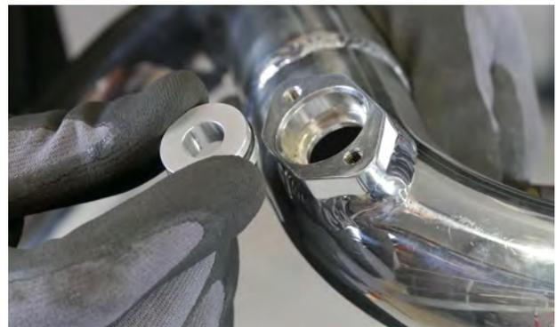
11. Verbauen Sie den MAP-Sensor aus dem originalen Ladeluftkühler, zusammen mit der mitgelieferten Alu-Dichtung und Montagematerial im HF-Series Druckrohr. Dieses Druckrohr wird mit einem SF-Hoses Silikonschlauch am oberen Ladeluftkühleranschluss angebaut und verläuft von dort zur Ansaugbrücke. In diesem Zuge wird der Stecker für den MAP-Sensor wieder angeschlossen und die Schläuche mit den passenden Schlauchschellen versehen.
