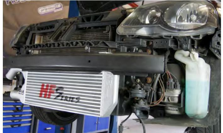
10. Das neue Ladeluftkühlerpaket, bestehend aus Stoßstangenträger und Ladeluftkühler wird an die originalen Haltepunkte montiert.
