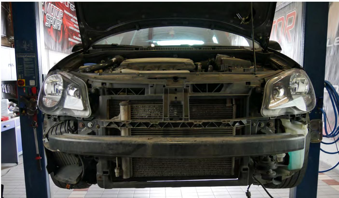
7. Nachdem die Stoßstange demontiert ist, können alle Teile vom Ladeluftkühler entfernt werden. Dazu gehört die Luftführung, welche festgeklippt ist, der Stecker hinter dem Sammler und der unter Druckschlauch.
